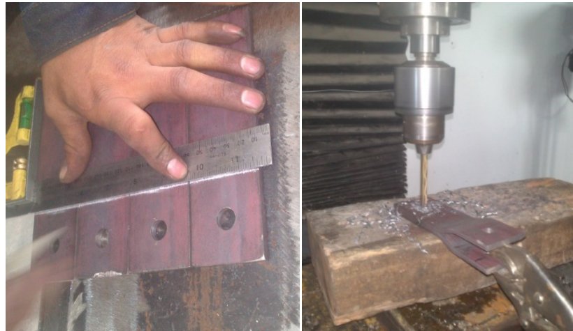
Figura 5.18: Corte, perforación de sujeción sensores
