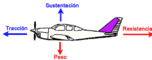
Figura 2.12: Fuerzas que actúan en vuelo
