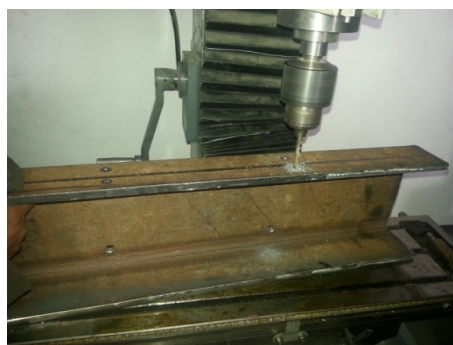
Figura 5.5: Perforación de la base de sujeción
