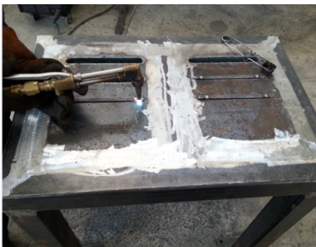
Figura 5.11: Corte de los huecos de sujeción
