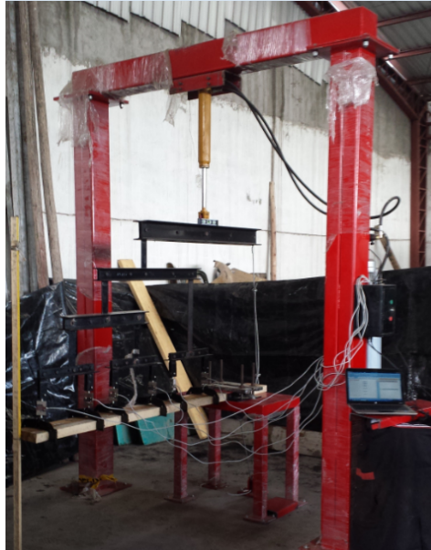
Figura 5.22: Banco de resistencia estructural
