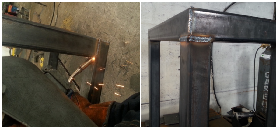
Figura 5.7: Soldadura de la mesa
