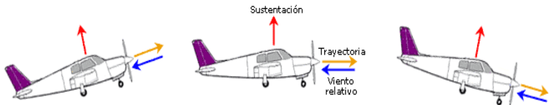
Figura 2.16: La sustentación es perpendicular al viento relativo
