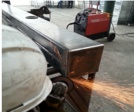
Figura 5.3: Soldadura de las tapas de la viga superior
