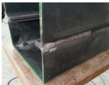
Figura 5.2: Soldadura de los perfiles en G
