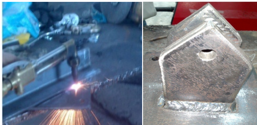
Figura 5.21: Corte, suelta de la base de la polea
