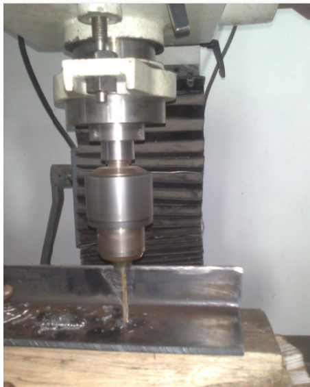
Figura 5.17: Perforación de la base de sujeción
