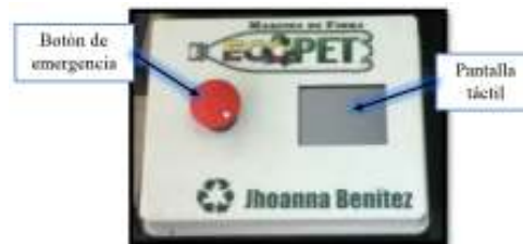
Fig 24. Caja de control.
