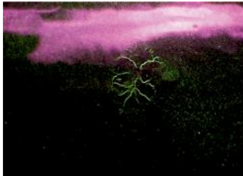
Figura 172. Indicación de fisuras tipo estrella producidas por líquido penetrante fluorescente
