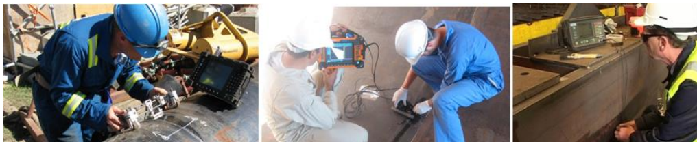
Figura 9. Detección de discontinuidades mediante ultrasonidos
