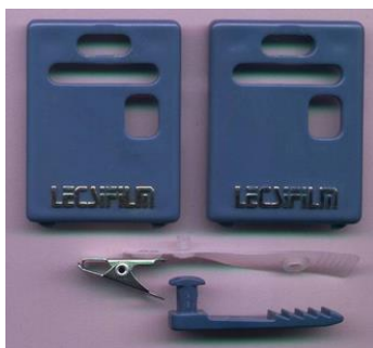
Figura 44. Dosímetro de película
