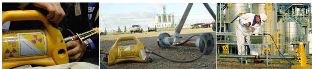
Figura 11. Detección de discontinuidades mediante radiografía
