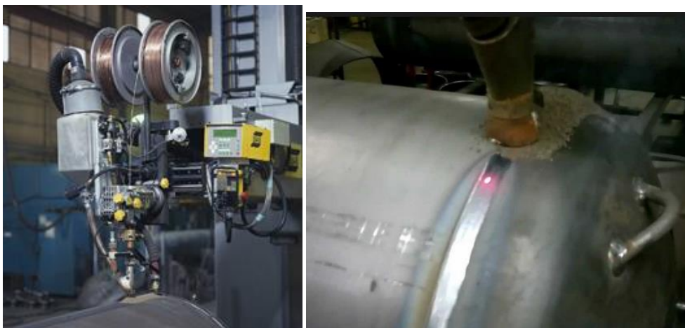
Figura 75. Soldadura de arco sumergido
