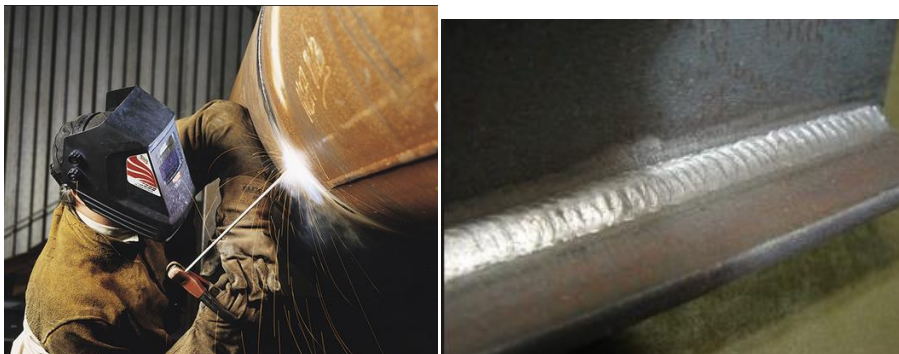
Figura 60. Soldadura por arco con electrodo revestido
