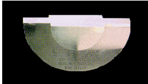
Figura 139. Bloque de calibración DC
