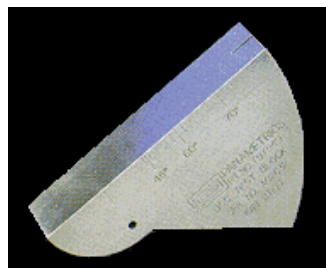
Figura 138. Bloque de calibración DSC
