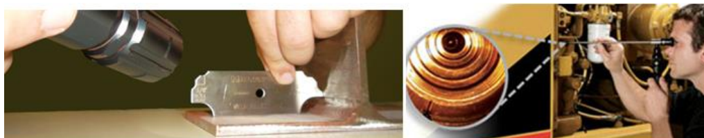
Figura 1. Ensayo visual: con galgas (izquierda) y boroscopio (derecha)
