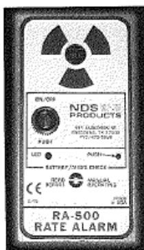
Figura 46. Alarma de tasa de dosis
