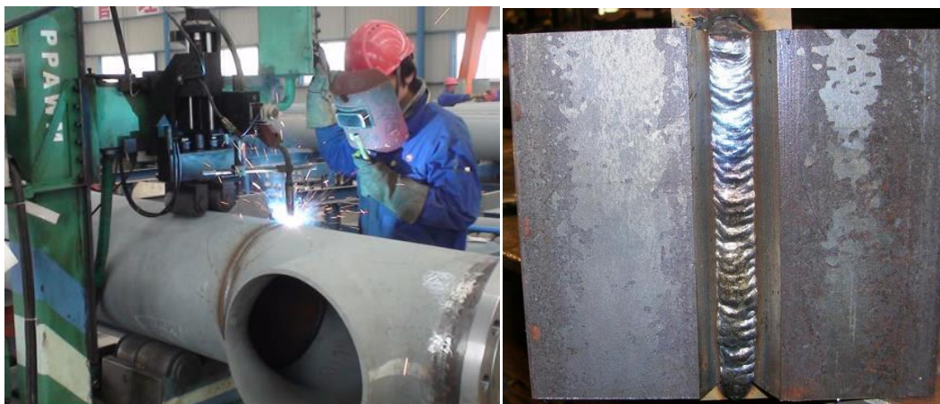
Figura 70. Soldadura de arco con núcleo fundente
