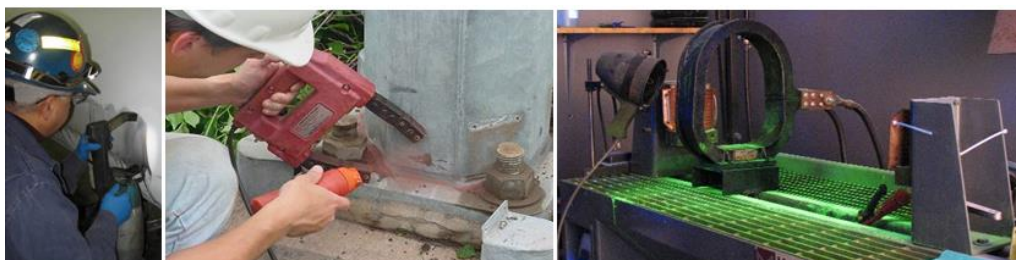
Figura 5. Detección de discontinuidades mediante partículas magnéticas
