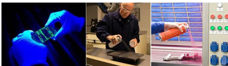
Figura 3. Detección de discontinuidades mediante líquidos penetrantes
