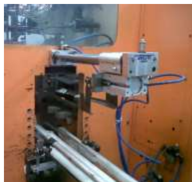
Figura 2. 3. Pistón de transporte de botellas
