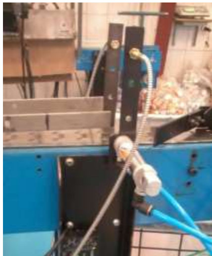
Figura 3. 18. Regulación de altura del sensor fotoeléctrico
