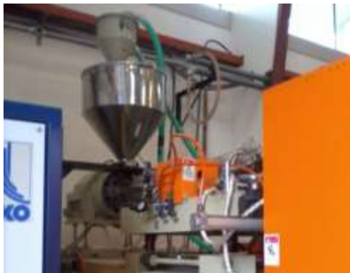
Figura 3. 6. Colocación de la tolva almacenadora
