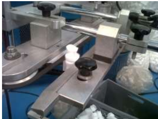
Figura 3. 11. Calibración de banda y ancho para el paso de botellas
