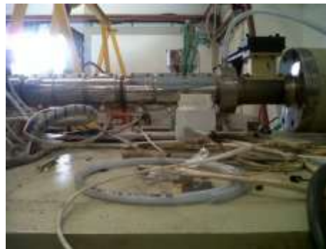
Figura 3. 3. Instalación de extrusor y colocación de resistencias
