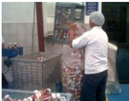
Figura 2. 5. Empacado de botellas plásticas
