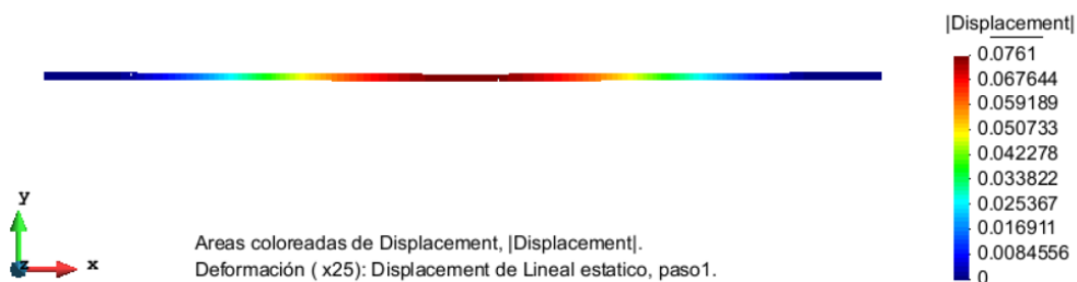
Ilustración 144: Resultado desplazamiento Eje
