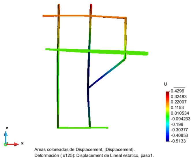
Ilustración 39: Desplazamiento Estructura - Eje X
