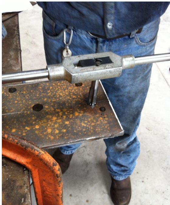
Ilustración 169: Machuelado de placas roscadas
