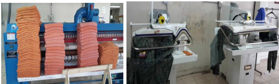
**Figura 24.** Plancha Industrial y Planchas Pequeñas respectivamente.
