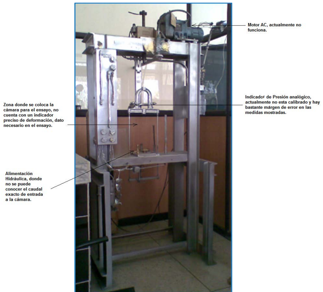
Figura 10 Instrumentación de la máquina Triaxial Chicago Soiltest.
