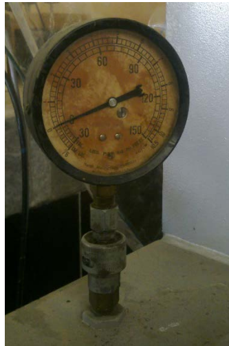
Figura 13 Manómetro instalado en la máquina Triaxial Chicago Soiltest.
