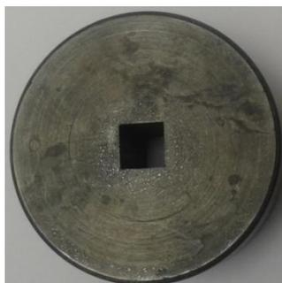
**Figura 50: Dado de corte de secciones cuadradas antes de la rotura.**
