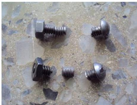
**Figura 4: Fragmentos de perno (resultado del ensayo de esfuerzo cortante). (Fuente: Laboratorio de Mecánica de Materiales de la Universidad de las Fuerzas Armadas – ESPE)**
