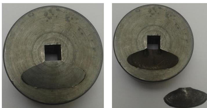
**Figura 51: Dado de corte de secciones cuadradas después de la rotura.**
