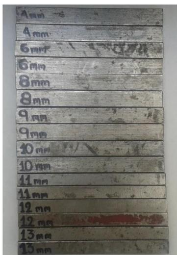
**Figura 59: Galgas de espesores.**
