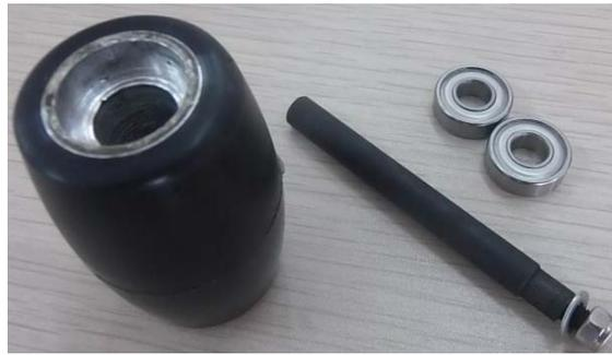
**Figura 44** Conjunto rodillo, eje, rodamientos, arandela y tuerca
