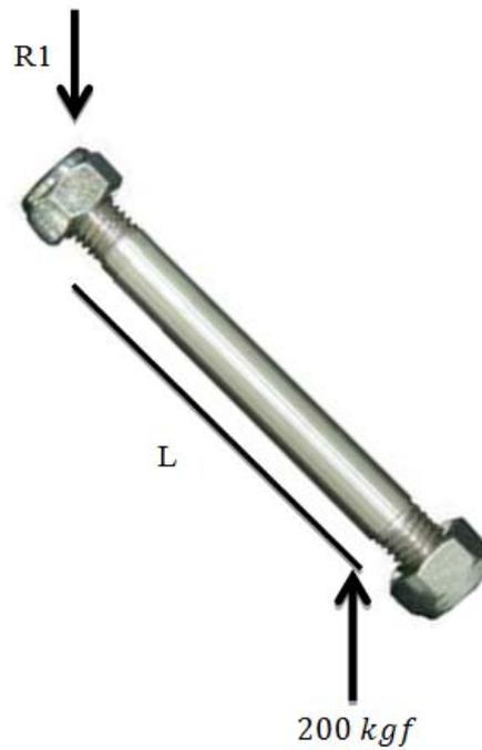
**Figura 47 Eje del rodillo a 45°**
