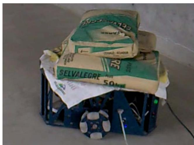
**Figura 120 Plataforma con 150 *kgf* de carga**
