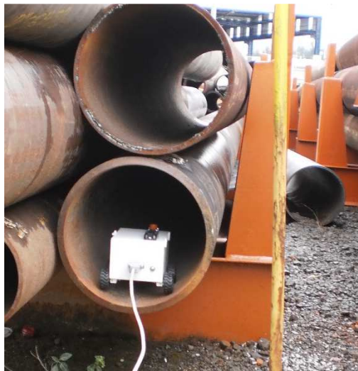
Figura 84. Prueba en Tubo de 10 plg.
