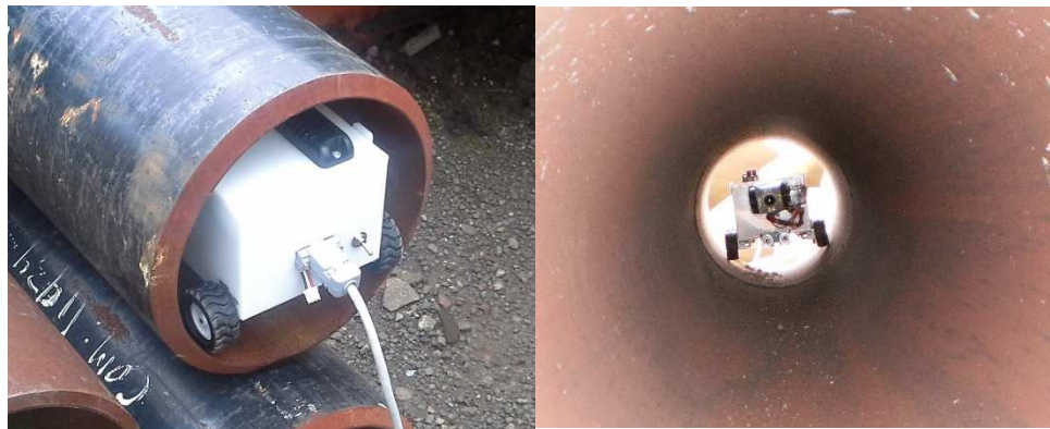
Figura 83. Prueba en Tubería de 8 plg.
