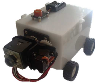
Figura 79. Resultado Final del Robot para Inspección de Tubería
