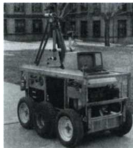
Figura 21. Robot Terragator Configuración Skid Steer
