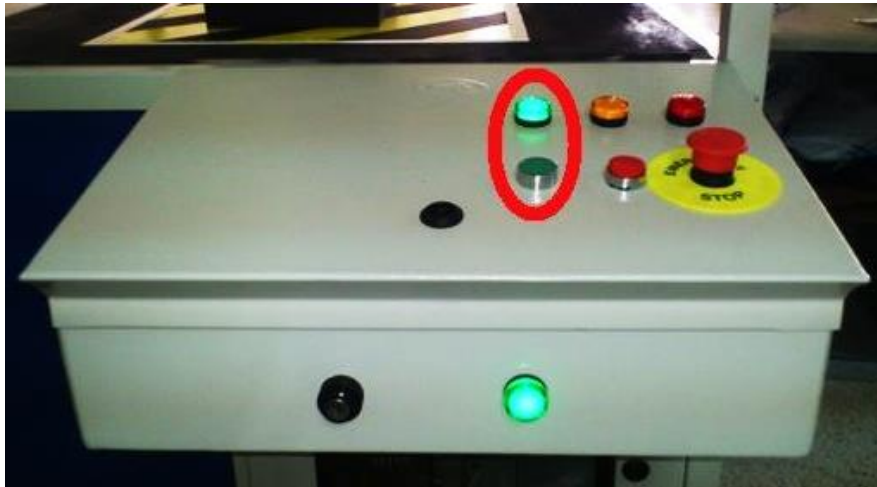
Fotografía 4. Imagen referente a como se visualiza cuando la estación robótica cartesiana está activada
