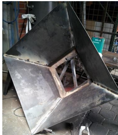
Figura No. 68: Tolva de alimentación: unión de todas las partes mediante soldadura
