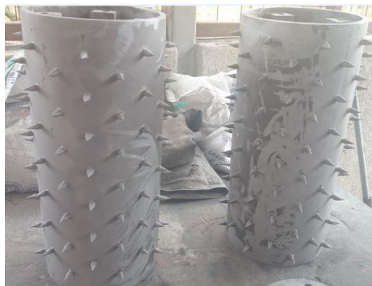
Figura No. 71: Sandblasting y acabado final de los rodillos
