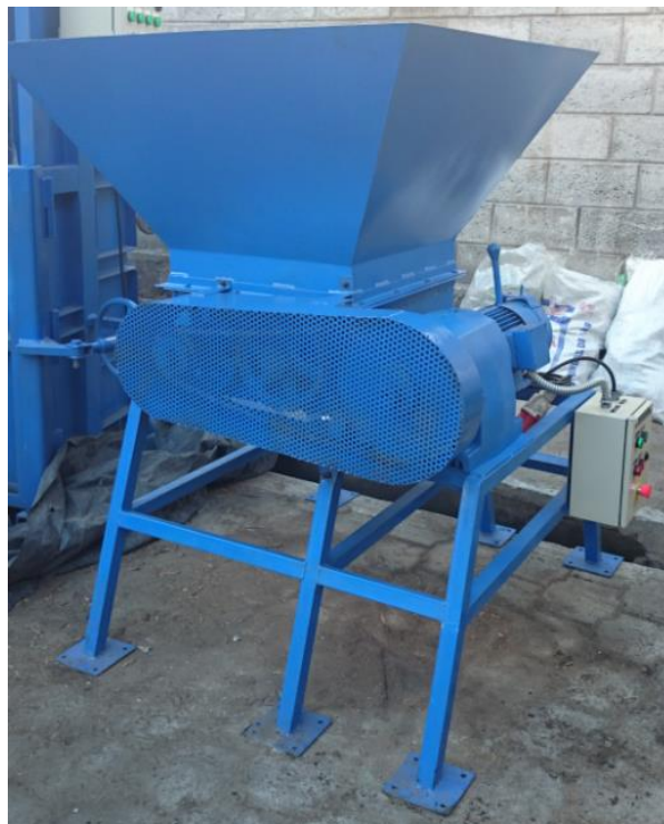
Figura No. 83: Prototipo de máquina perforadora de botellas de PET
