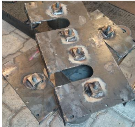
Figura No. 78: Placas frontal y posterior terminadas, con refuerzos para chumaceras y pernos de comprobación
