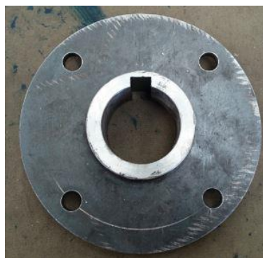
Figura No. 73: Conjunto tapa – soporte de los rodillos soldado y con sus respectivos chavetero y agujeros para pernos
