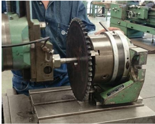
Figura No. 76: Cepillado de los elementos de transmisión de potencia
