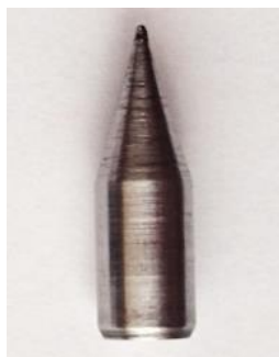
Figura No. 69: Punta perforadora después de haberle quitado el óxido residual del tratamiento térmico (cementado), lista para ser soldada al rodillo
