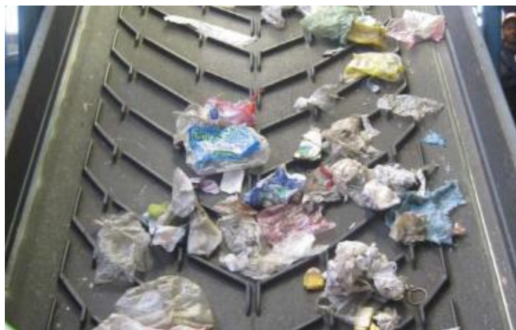
Figura No. 54: Banda transportadora tipo CHEVRON
