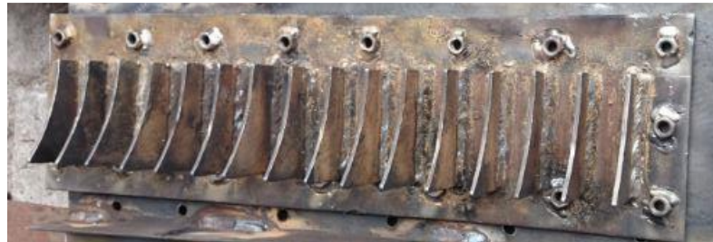
Figura No. 74: Placa base izquierda con sus topes laterales y tuercas soldadas
