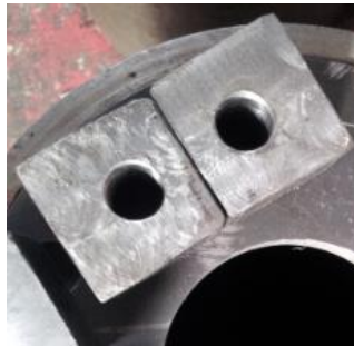
Figura No. 70: Acabado final de cubos de fijación de tapas de rodillos
