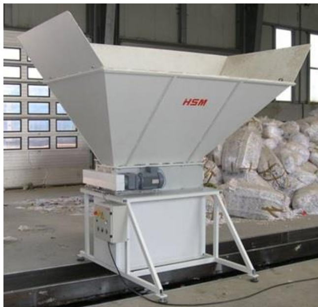
Figura No. 5: Sistema de Perforado PET HSM PF 600
