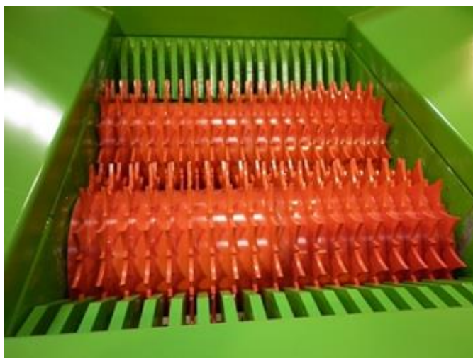
Figura No. 4: Cuchillas del perforador de botellas HEL 600
