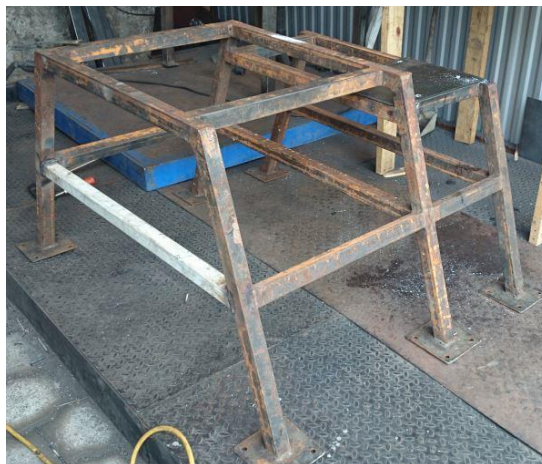
Figura No. 79: Estructura soldada completamente, con sus respectivas placas base para motor y caja de control
