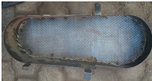
Figura No. 77: Protección para los elementos de transmisión de potencia
