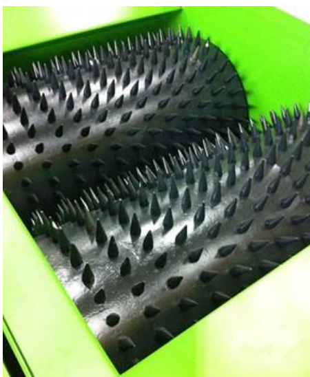
Figura No. 6: Rodillos del perforador de botellas de BOLLEGRAF
