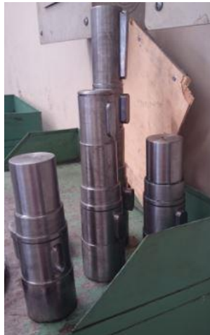
Figura No. 72: Ejes terminados, con sus respectivas ranuras para anillos de retención y chaveteros
