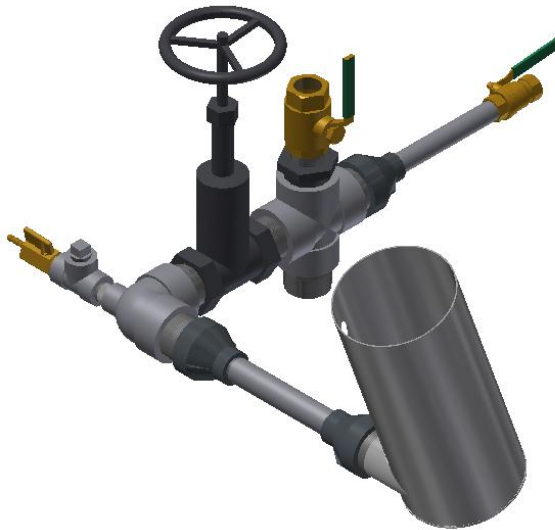
Figura 37 Esquema del Venturi adaptado al quemador
