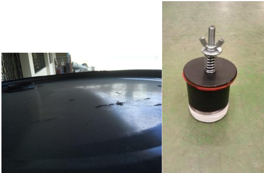
Figura 23 Fotografía tapa de tolva y válvula de alivio.
