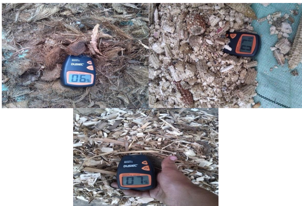
Figura 51 Fotografía de medición del porcentaje de humedad de los 3 tipos de biomasa
