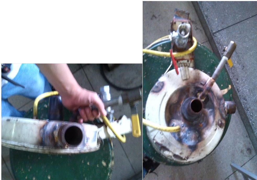
Figura 38 Fotografía del depurador adaptado válvulas de admisión de aire
