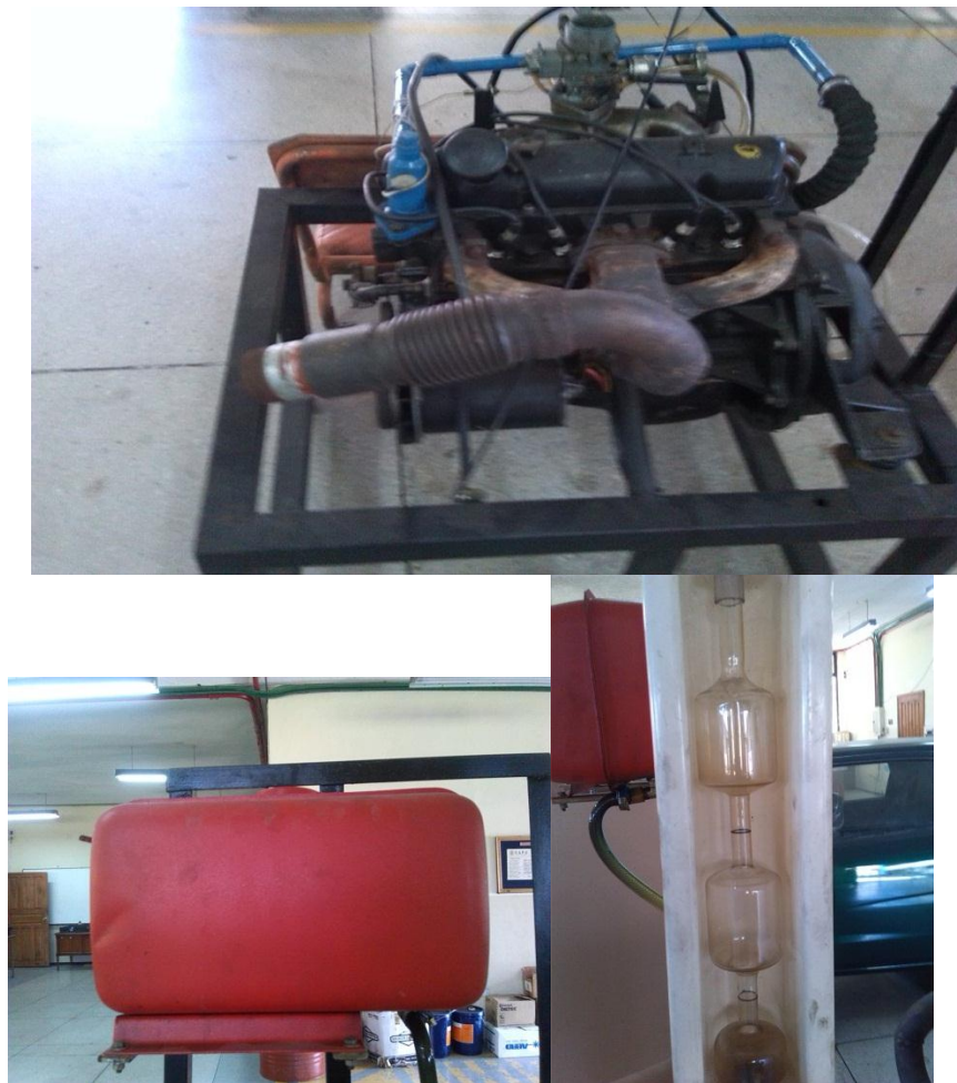
Figura 17 Fotografía Estructura y soportes del motor
