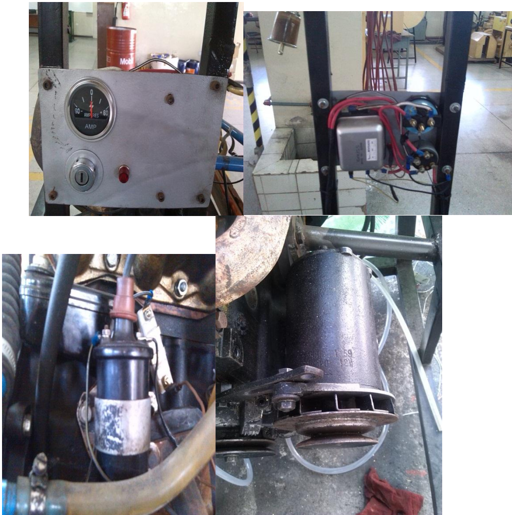
Figura 19 Fotografía de componentes eléctricos reemplazados
