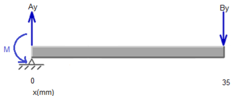
Fig. 49. Diagrama de Cuerpo Libre Eje
