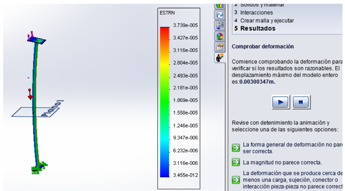
Fig. 62. Deformación de los soportes
