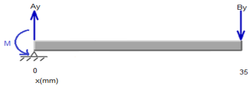
Fig. 43. Diagrama de Cuerpo Libre Eje
