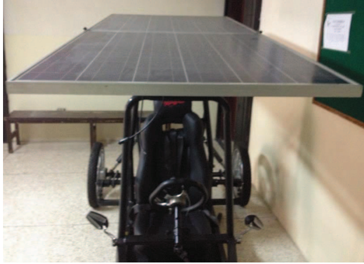
Figura 6 Paneles de 96W
