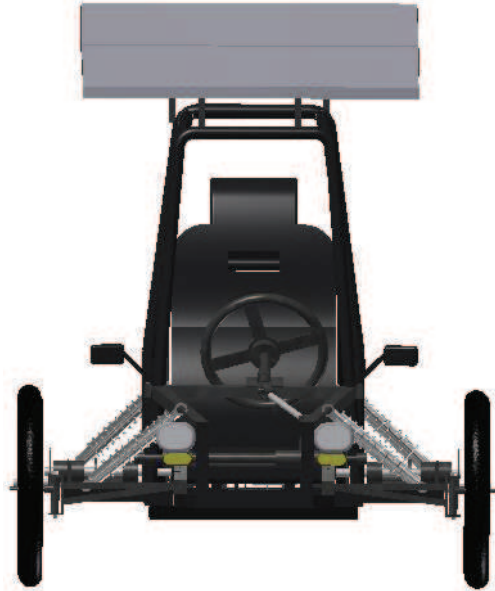
Figura 38 Vista de luces frontales del Go Kart
