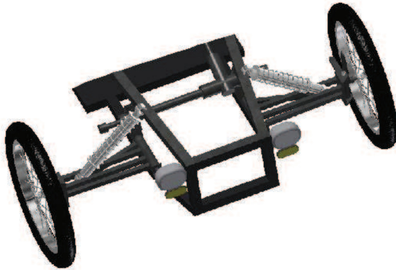
Figura 22 Brazos delanteros con amortiguación independiente
