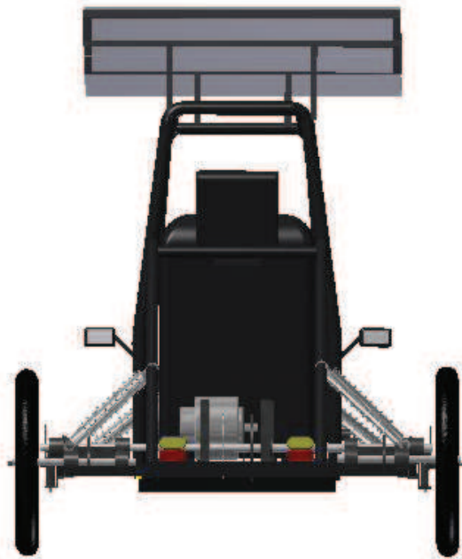
Figura 39 Vista de luces traseras del Go Kart
