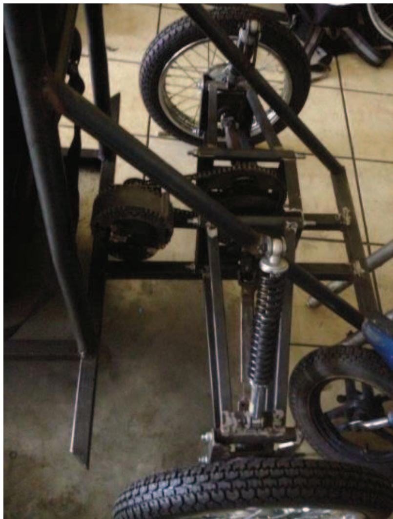
Figura 25 Primer diseño brazos traseros y tracción mecánica (completo)
