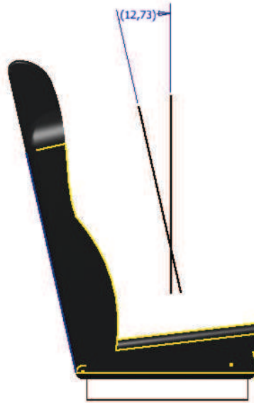
Figura 33 Control de medida máxima del ángulo del asiento
