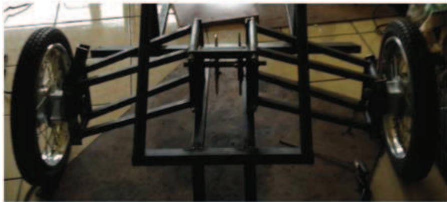
Figura 24 Primer diseño brazos traseros y tracción mecánica (incompleto)
