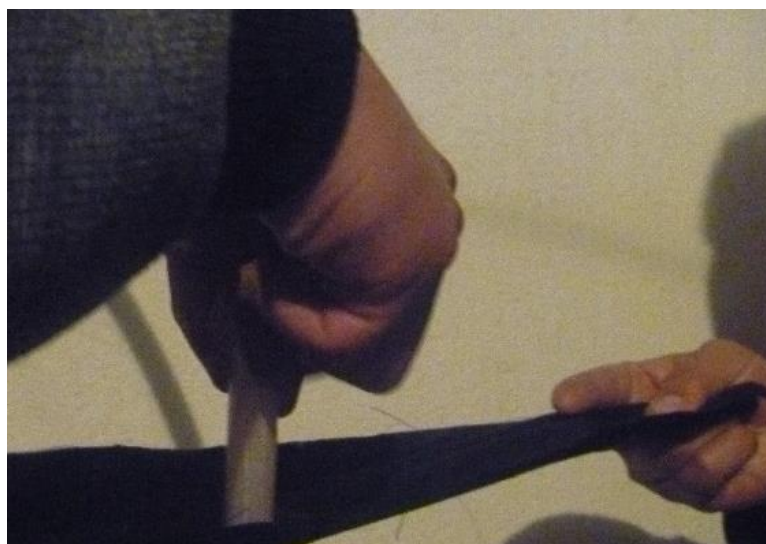
Figura 118: Colocación del tubo circular de forma perpendicular a la tela impermeable.
