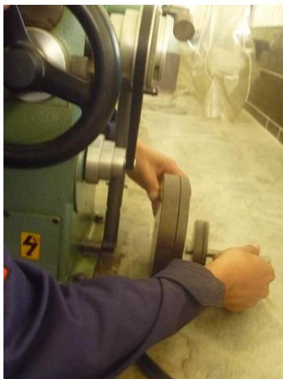
Figura 102: Pesas para la aplicación de la fuerza del ensayo.
