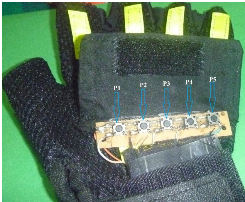
Figura 92: Guante de control con los pulsadores de activación de funciones.
