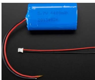
Figura 34: Batería de ion de litio de 4400 mAh. Fuente: (Liu, Zhu, & Xiao, 2009)
