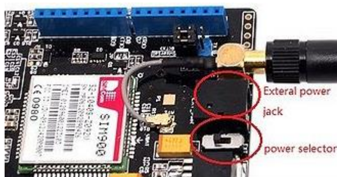
Figura 53: Selector de fuente de poder y conector de poder exterior. Fuente: (seedstudio, GPRS Shield V1.0, 2014)
