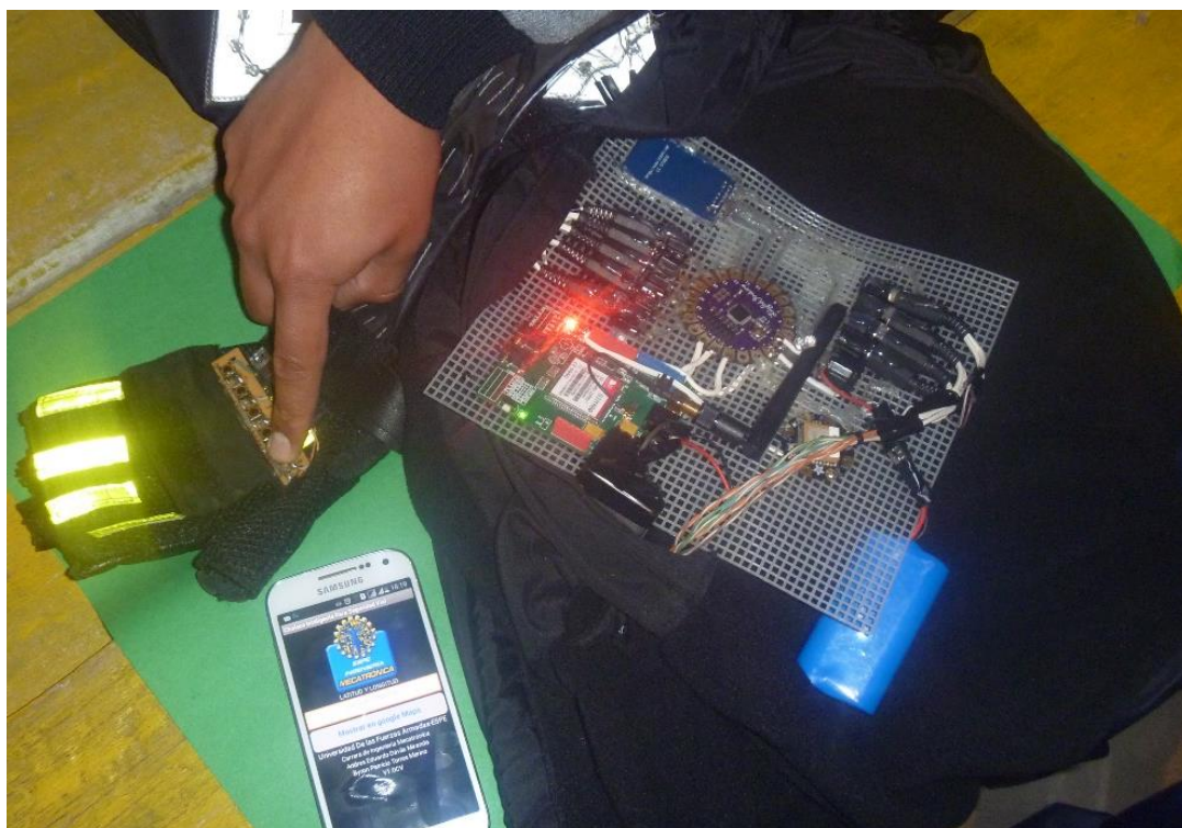
Figura 116: Accionamiento del pulsador para él envío de información hacia un teléfono celular.
