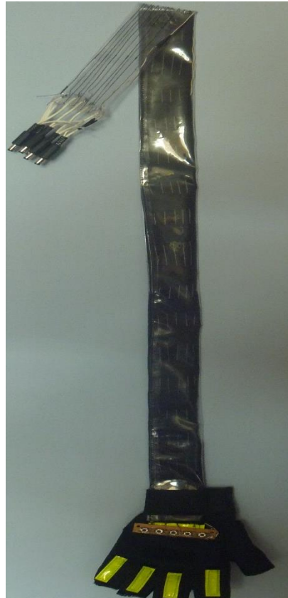
Figura 93: Guante de control y conectores plugs.
