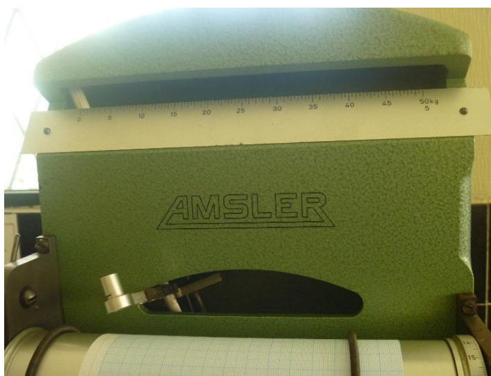
Figura 101: Escala para la medición de la fuerza de tracción.
