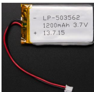
Figura 35: Batería de Litio de 1200 mAh. Fuente: (Sunping, 2012)
