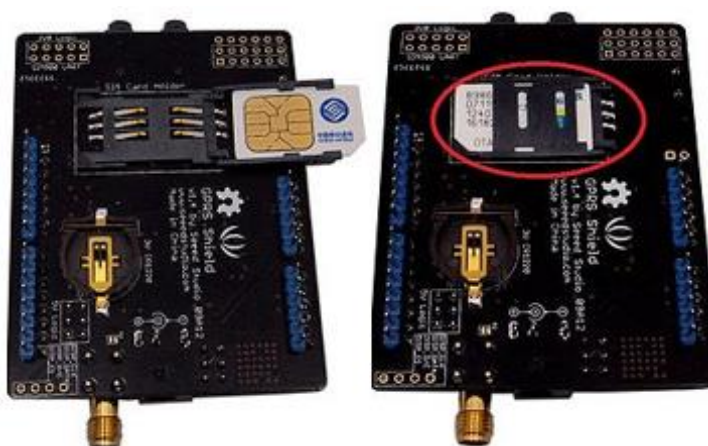
Figura 60: Zócalo para la tarjeta SIM.
