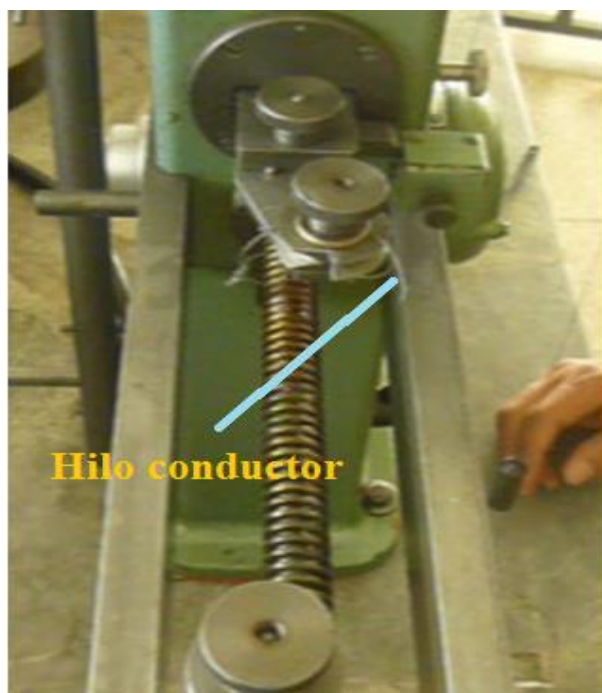
Figura 104: Estado del hilo luego del ensayo de tracción.
