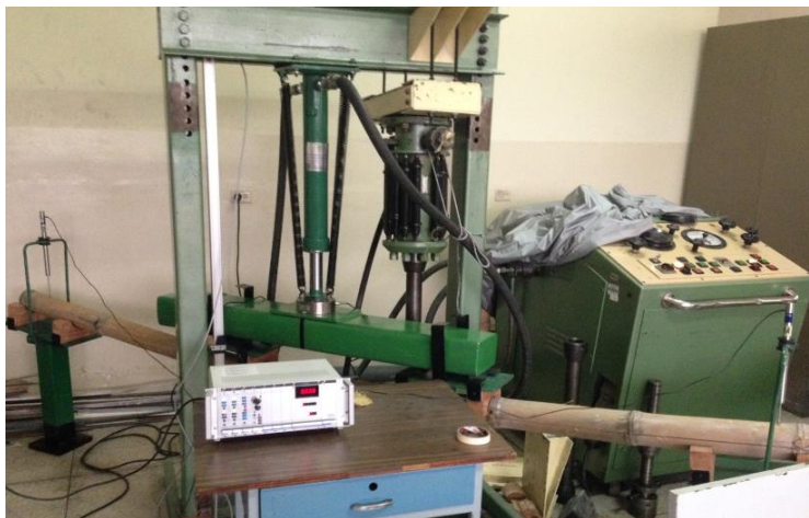
Gráfico No 56: Ensayo de flexión en bambú en el LMM.
