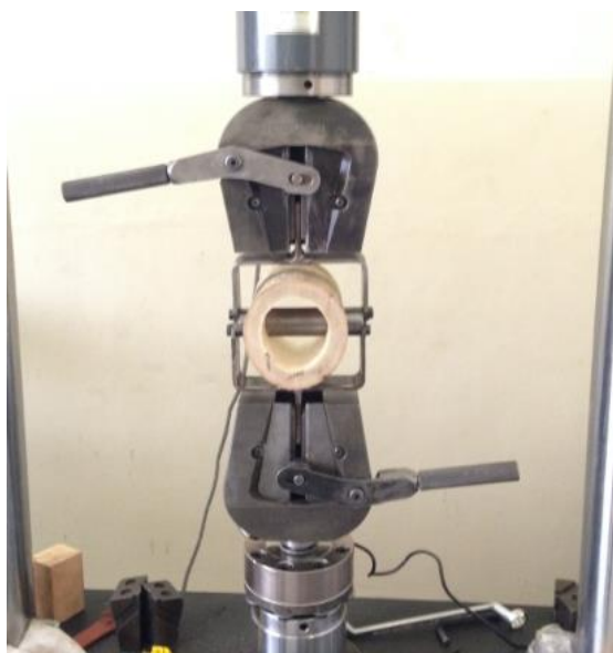
Gráfico No 65: Ensayo tracción perpendicular a las fibras en bambú, en el LMM.
