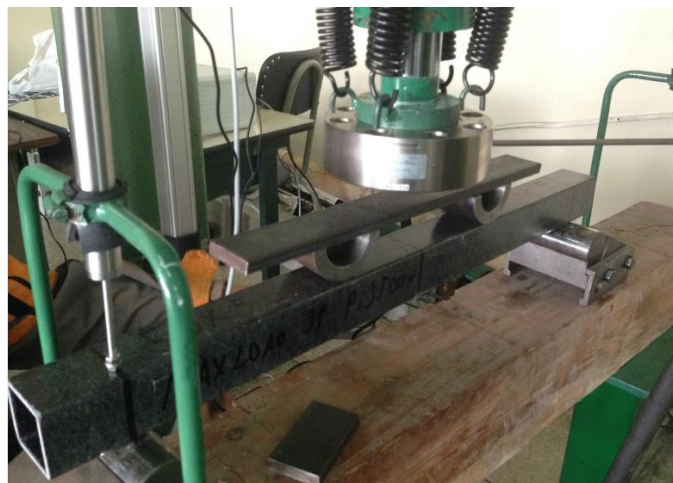
Gráfico No 49: Ensayo de flexión en dos puntos de carga a velocidad constante, hasta una carga de 7000 N en viga de 50X50 (mm)
