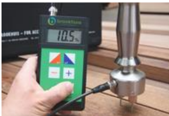
Gráfico No 34: Higrómetro, sonda medidor de humedad brookhuis modelo FMC, similar a utilizar en el laboratorio.
