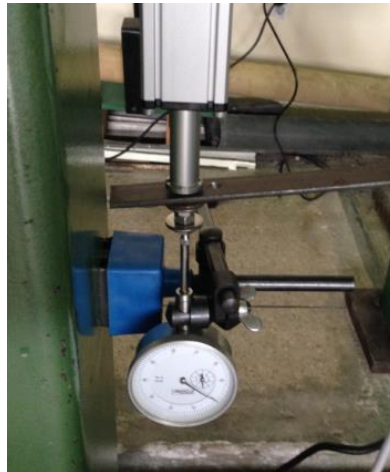
Gráfico No 33: Comprobación del desplazamiento del transductor ER
