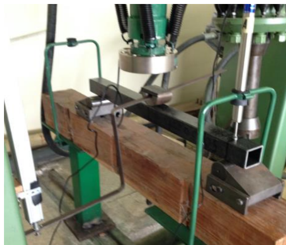
Gráfico No 47: Ensayo de flexión en un punto de carga a velocidad constante hasta una carga de 3500 N en viga de 50X50 (mm)
