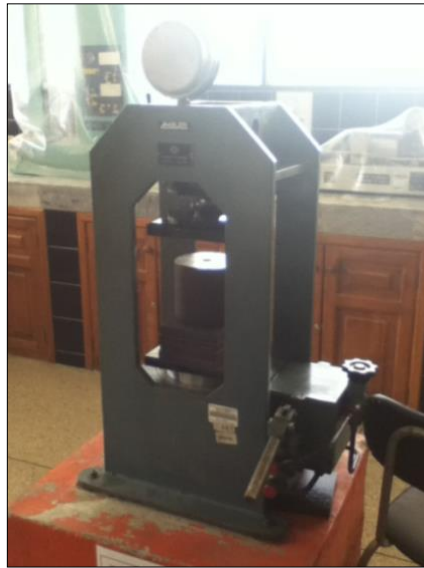
Gráfico No 1: Prensa hidráulica de 100 ton del LMM, Universidad de las Fuerzas Armadas ESPE
