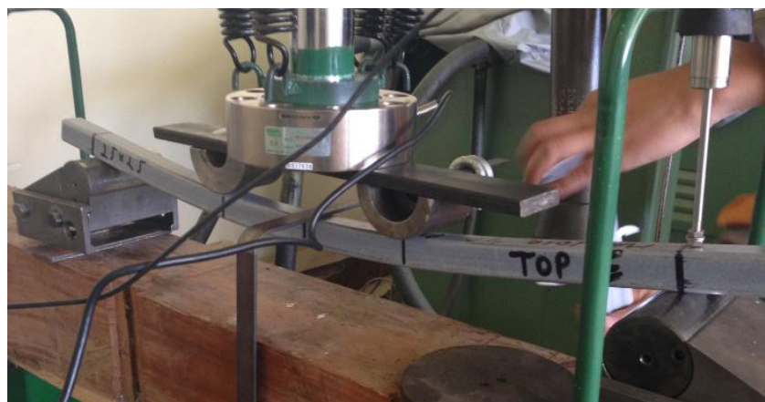
Gráfico No 53: Ensayo de flexión en dos punto de carga a velocidad constante, hasta a una carga de 3000 N en viga de 25X25 (mm)
