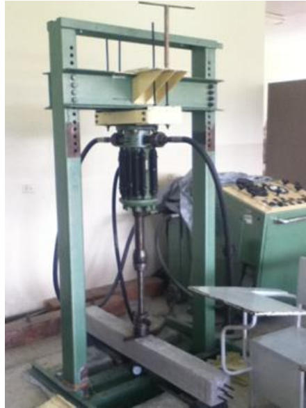
Gráfico No 3: Vibróforo de Baja Frecuencia del LMM, Universidad de las Fuerzas Armadas ESPE
