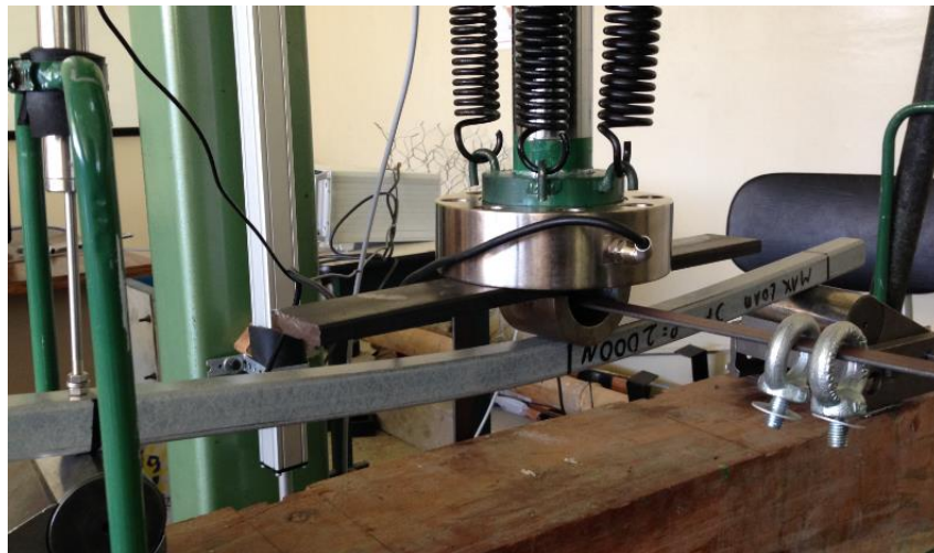
Gráfico No 51: Ensayo de flexión en dos puntos de carga a velocidad constante, hasta a una carga de 2000 N en viga de 25X25 (mm)
