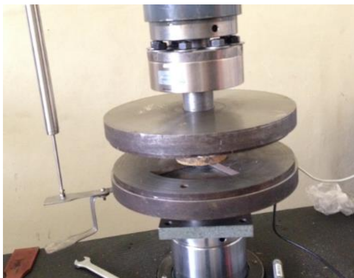
Gráfico No 59: Ensayo de corte en bambú, en el LMM.
