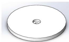
**Figura 3.19 Placa de la Cremallera. Diseñado en Solidworks™**
