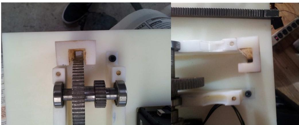
**Figura 4.3 Ensamble del segundo eje**
