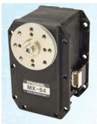
**Figura 3.21 Motor Dynamixel MX64-T<sup>65</sup>**
