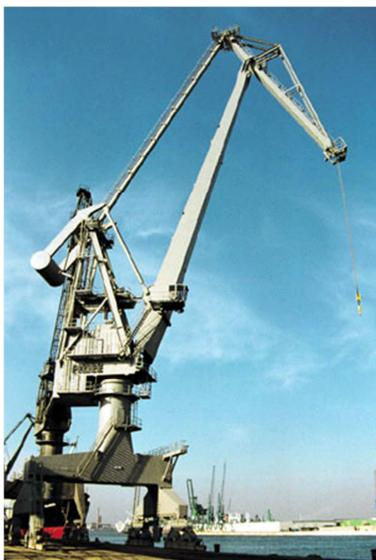
Figura 2.3 Grúa de Amantillado<sup>5</sup>
