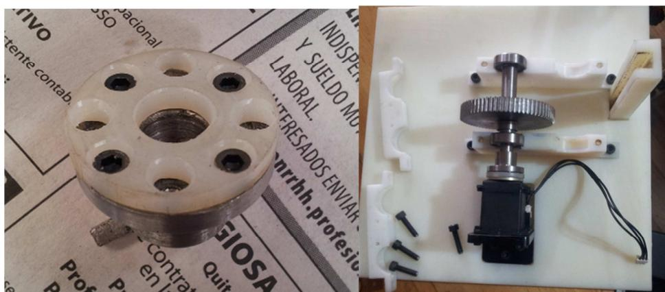
**Figura 4.2 Pieza diseñada para acoplar el eje 1 al eje del motor**
