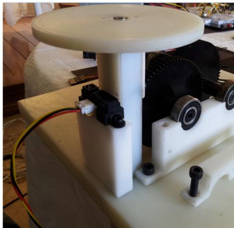
**Figura 4.4 Placa cilíndrica de duralón y sensor ensamblado**
