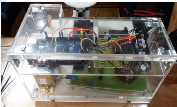
**Figura 4.10 Ensamble de la caja de acrílico y elementos electrónicos**
