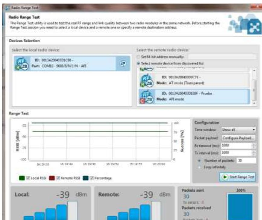
**Figura 60. Medición del parámetro RSSI en la ventana Radio Range Test**
