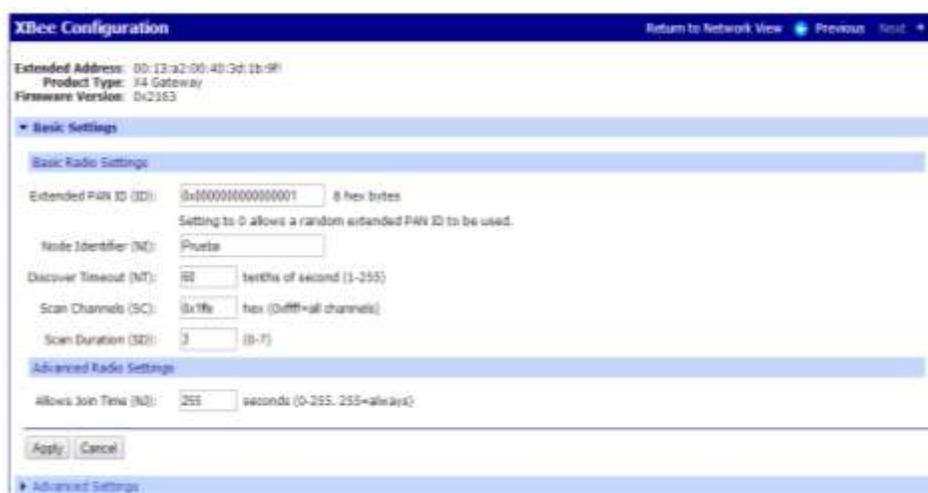
**Figura 22. Configuración del dispositivo coordinador**
