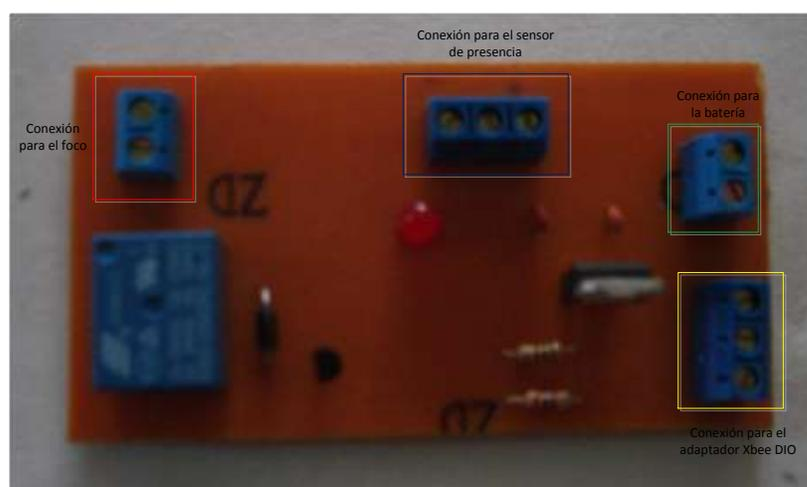
**Figura 56. Placa del control de iluminación**
