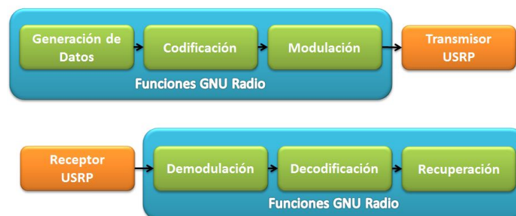
Figura 8: Funciones de procesamiento en cadena de transmisión y recepción en GNU Radio.
