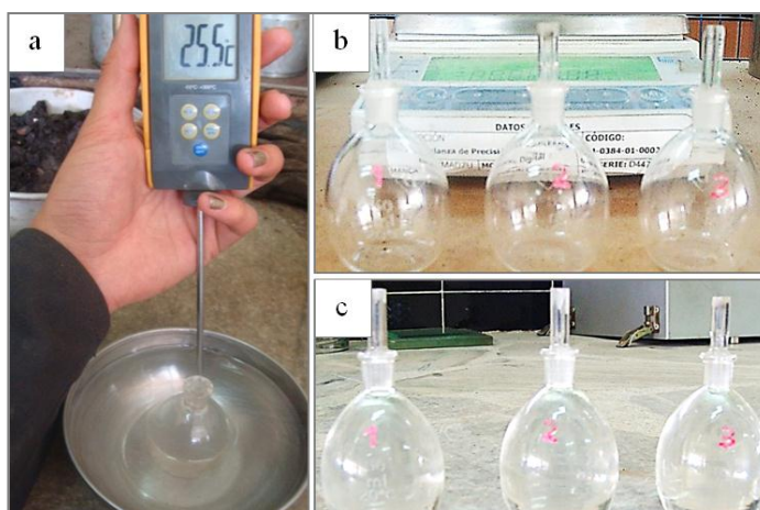
Fotografía 30. Baño de agua 25°C (a); peso del picnómetro más tapón (b); peso del picnómetro más tapón y más agua (c)
