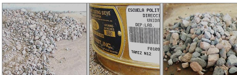
Fotografía 25. Material tamizado por la malla No.12
