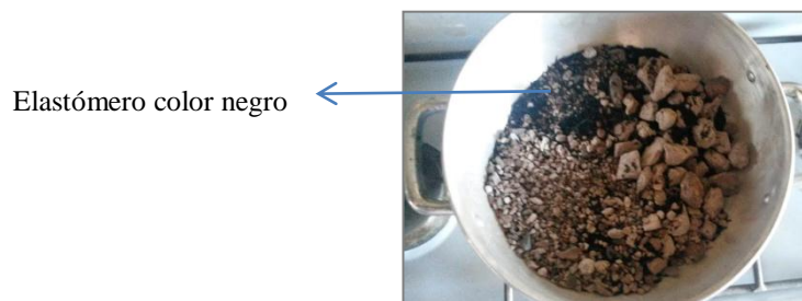
Fotografía 63. Agregados combinados con elastómero
