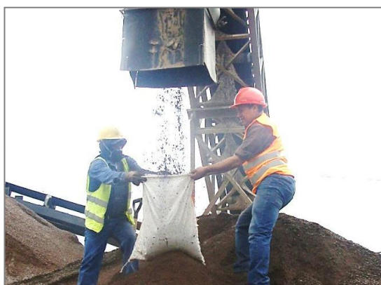
Fotografía 11. Muestreo de agregado fino
