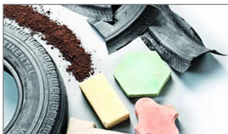
Fotografía 4. Adoquines fabricados con caucho de llantas recicladas
