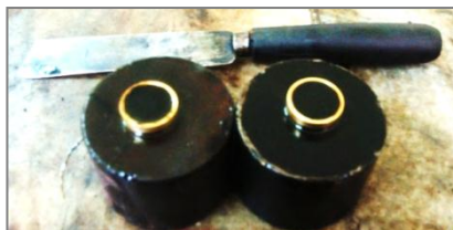
Fotografía 36. Muestra preparada, anillos con asfalto
