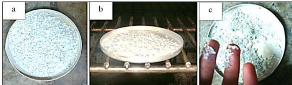
Fotografía 45. Muestra de escarcha de RPET a ensayar (a); muestra en el horno a 150°C (b); escarcha luego del período en el horno (c)
