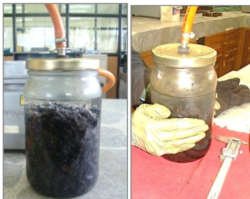
Fotografía 59. Extracción de aire de la muestra cubierta de agua (a); conjunto agitado para acelerar la expulsión de aire (b)
