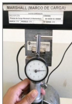
Fotografía 54. Posición firme del deformímetro
