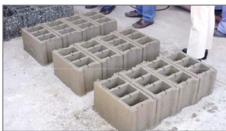
Fotografía 2. Ladrillos de plástico terminados
