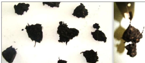
Fotografía 65. Partículas de material posterior a la disgregación de las briquetas
