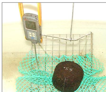
Fotografía 52. Lectura del peso sumergido – agua a 25^{\circ}\text{C} \pm 1^{\circ}\text{C}
