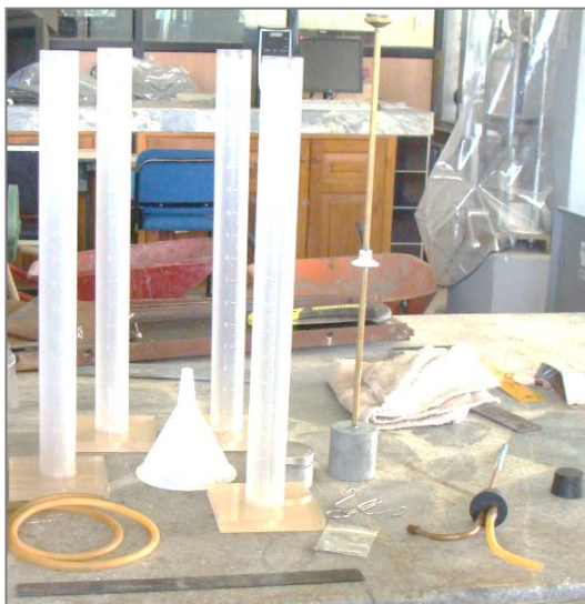
Fotografía 26. Equipo para equivalente de arena
