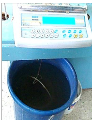
Fotografía 17. Muestra de agregado grueso en tanque de inmersión
