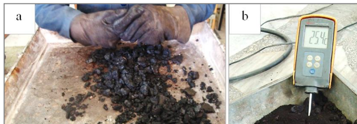
Fotografía 57. Briquea disgregada a mano (a); control de temperatura de la muestra (b)
