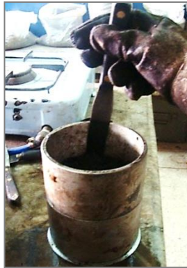
Fotografía 49. Golpes del palustre contra la mezcla en el molde
