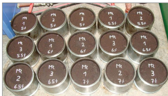
Fotografía 50. Briquetas compactadas en período de enfriamiento
