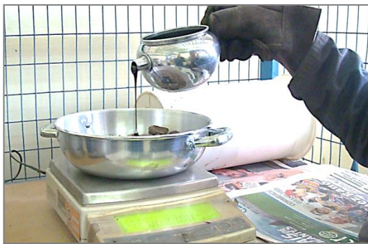
Fotografía 47. Vertiendo el asfalto a la mezcla de agregados
