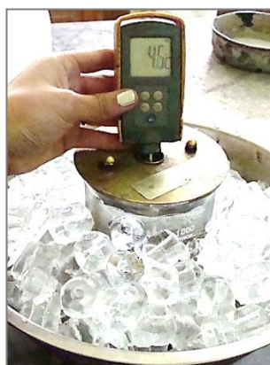
Fotografía 38. Control de temperatura hasta llegar a 5^{\circ}\text{C}\pm 1^{\circ}\text{C}
