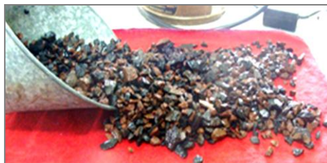
Fotografía 16. Eliminación del agua superficial del agregado
