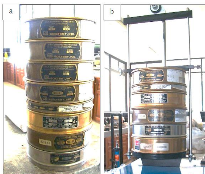
Fotografía 15. Serie de tamices (a); Tamizador eléctrico (b)
