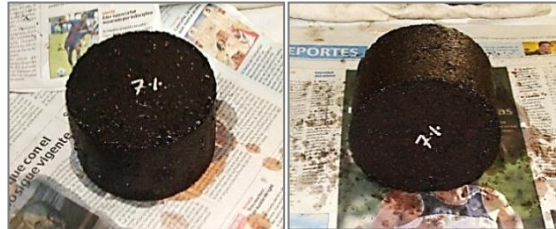
Fotografía 53. Se retira el agua superficial de la briqueta
