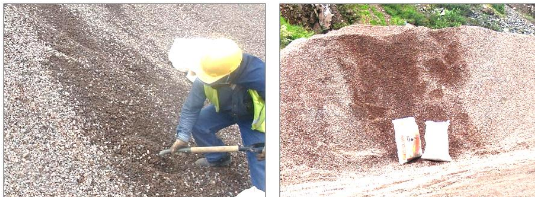
Fotografía 12. Muestreo de agregado grueso
