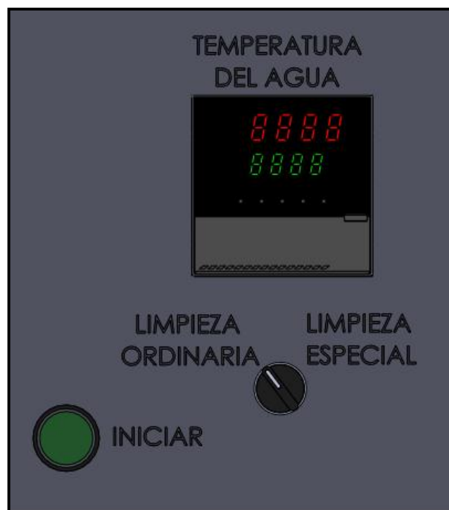
Figura 4.52 Dispositivos de control del sistema CIP.
