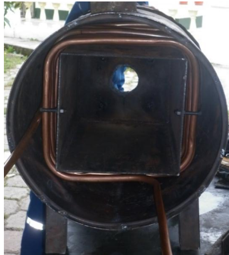
Figura 5.3 Serpentín del tanque de calentamiento.
