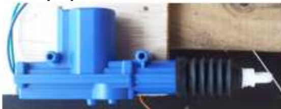
Figura 10. Actuador lineal de 20 [mm]
