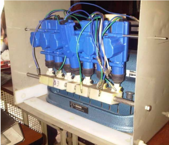
Figura 12. Soportes de nylon acoplados a los actuadores lineales
