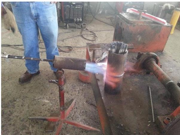
**Figura No. 41: Resecado de los electrodos.**
