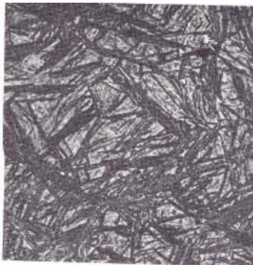
**Figura No. 82: Metalografía de martensita en un acero austeníticos.**
