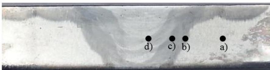
**Figura No. 77: Ubicación de las indentaciones realizadas en los ensayos**
