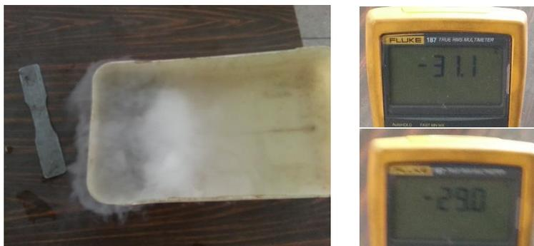
**Figura No. 67: Solución de hielo seco y alcohol industrial con el rango de temperaturas alcanzadas.**
