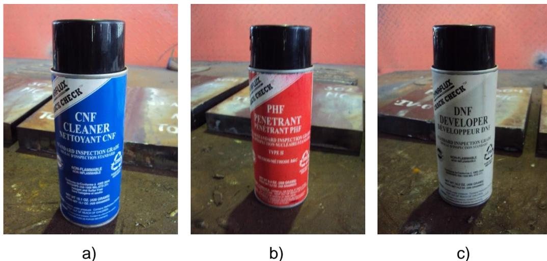
**Figura No. 49: Kit de tintas penetrantes a) Limpiador, b) Penetrante, c) Revelador.**
