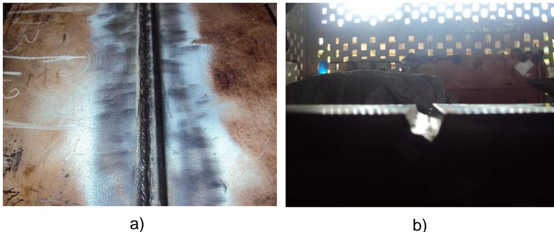
**Figura No. 45: Control de refuerzo de los cordones de la primera capa del procedimiento S01 a) Vista superior b) Vista frontal**
