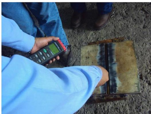
**Figura No. 46: Control de temperatura entre pases**
