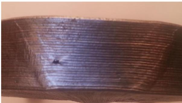
**Figura No. 64: Discontinuidad abierta en la cara convexa de la probeta S02-4.**
