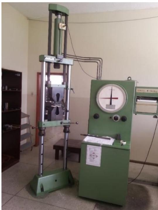
**Figura No. 59: Máquina de ensayos universales AMSLER FM-1033.**
