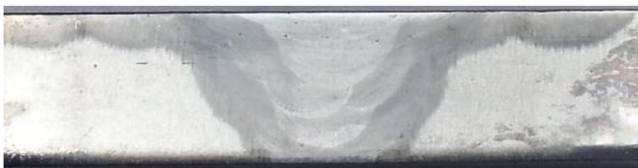
**Figura No. 80: Probeta atacada químicamente con nital al 3%.**
