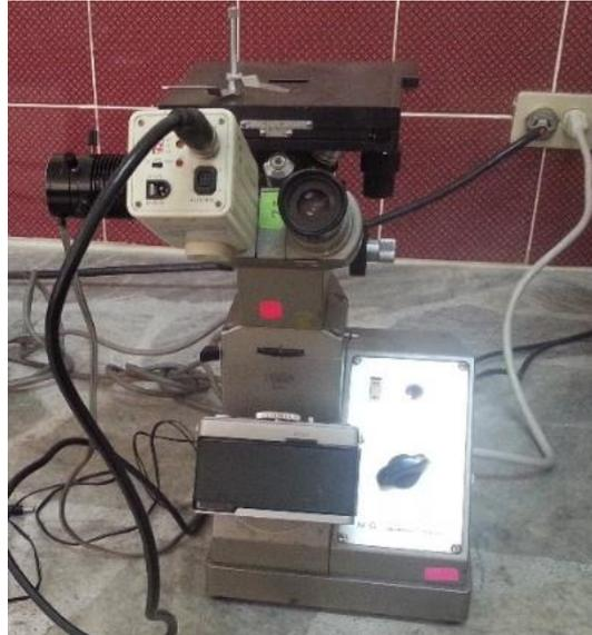
**Figura No. 81: Microscopio metalúrgico.**
