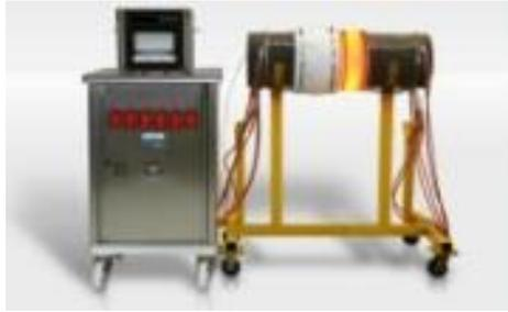
**Figura No. 3: PWHT realizado con resistencias eléctricas.
