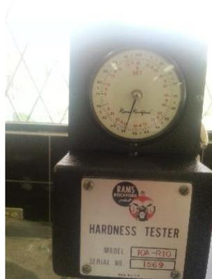
**Figura No. 74: Calibración del durómetro a escala Rockwell C.**
