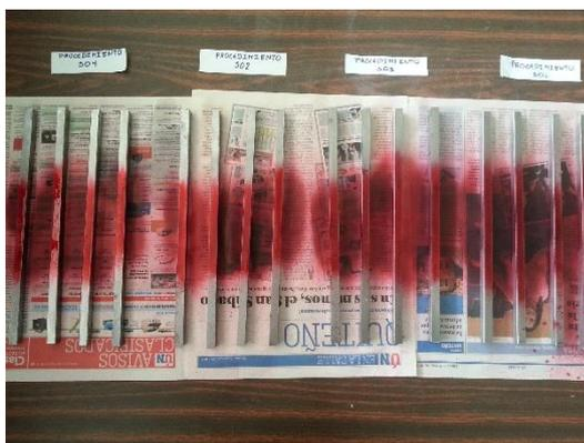
**Figura No. 55: Aplicación de tintas penetrantes en la probetas.**
