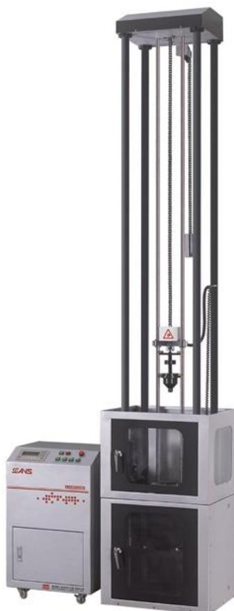
**Figura No. 8: Máquina para realizar ensayo de impacto por caída de peso.**
