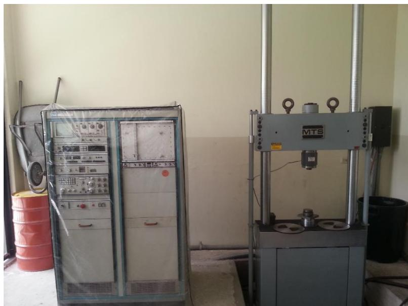
**Figura No. 56: Máquina de ensayos universales MTS-810.**
