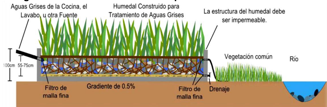
Figura 3 Un sistema subterráneo típico de humedales construidos
