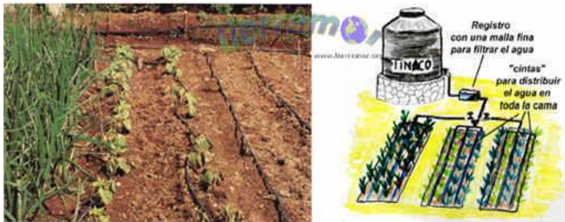
Figura 9 Sistema de riego con cintas
