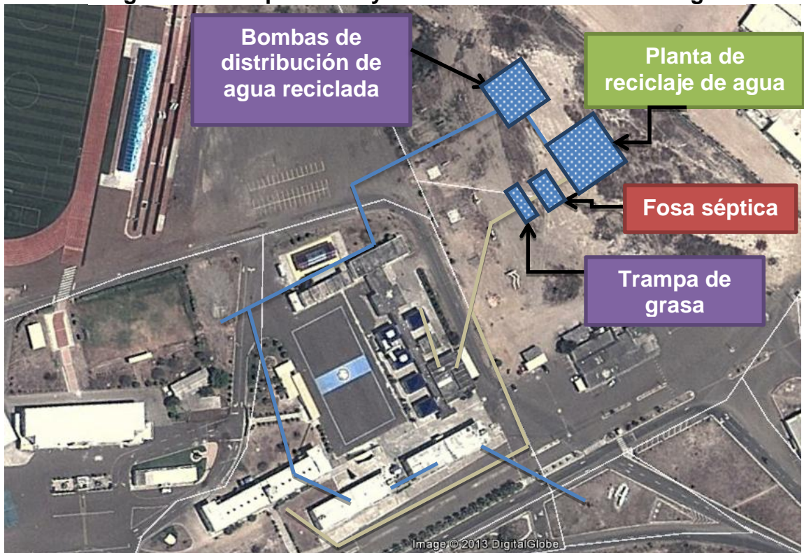
Figura 25 Componentes y sistema de distribución de agua
