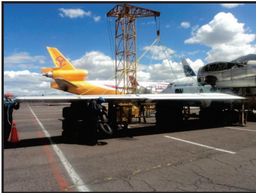
Figura 3.33 Desmontaje de la sección externa del ala
