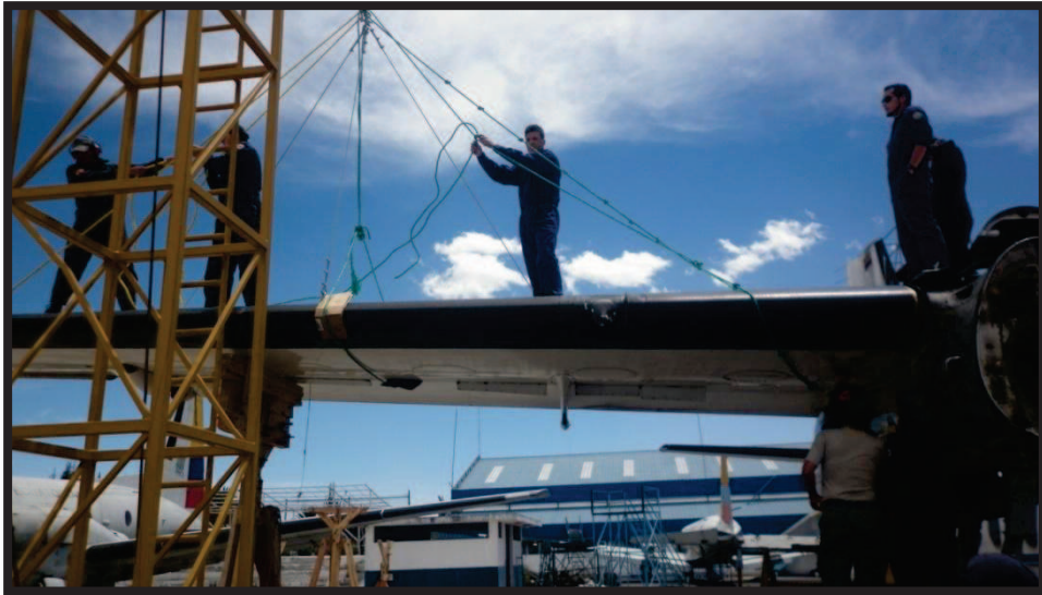
Figura 3.28 Aseguramiento del ala
