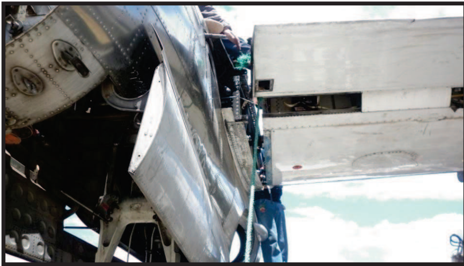
Figura 3.29 Izamiento del ala derecha
