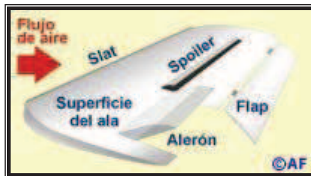
Figura 2.38. Superficies flexibles principales situadas en las alas de los aviones.
