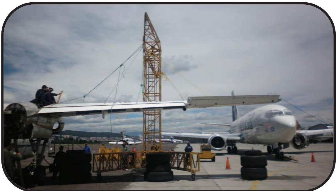
Fig. B12. Retiro de los soportes para la estabilidad del ala
