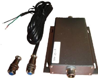
**Figura 37. Tarjeta analógica con salida de 4-20 mA**
