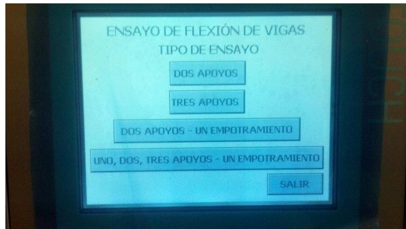
**Figura 67. Tipos de ensayos que muestra la HMI**
