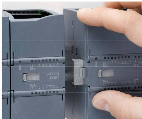
**Figura 62. Representación gráfica de comunicación PLC y módulo**
