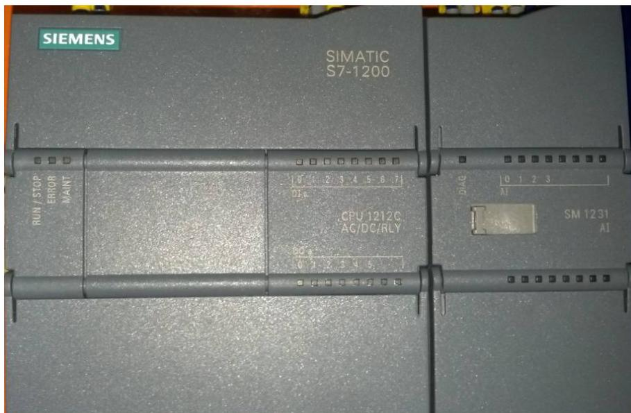
Figura 35. PLC 1212C y módulo de expansión Siemens SM1231
