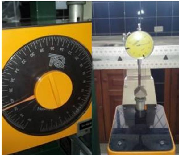
**Figura 1. Dinamómetro y comparador de reloj**
