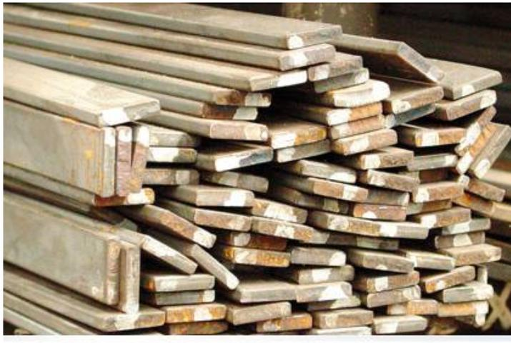
**Figura 51. Platinas de 50 mm de ancho y 9 mm de espesor**
