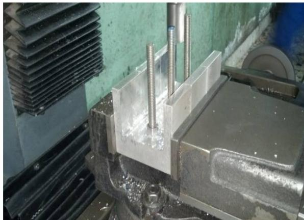
**Figura 53. Maquinado de perfiles en C**
