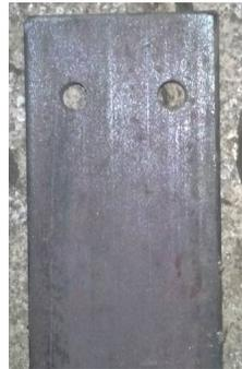
**Figura 58. Platinas de acero aleado bohler V945**
