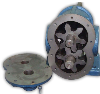
Figura No. 13: Bomba de engranajes exteriores rígidos. (Fernández, 2012).
