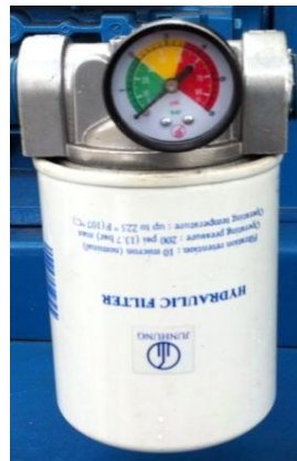
Figura No. 54. Filtro instalado en la centralina hidráulica.
