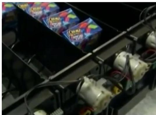
**Ilustración 1. 12 Motores acoplados a las espirales de una máquina expendedora**
