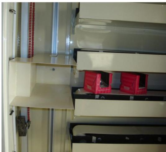
**Ilustración 3. 12 Ubicación de la cabina receptora en la parte superior de la banda transportadora**
