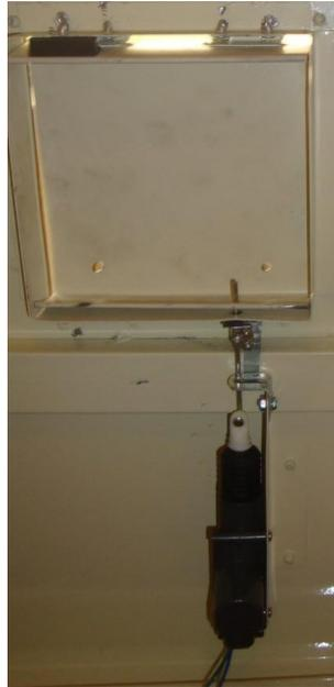
**Ilustración 3. 17 Puerta de expendio con motor y sensores**
