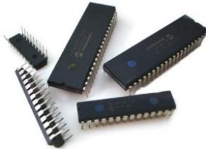
**Ilustración 2. 125 Microcontroladores, versión encapsulado PDIP**
