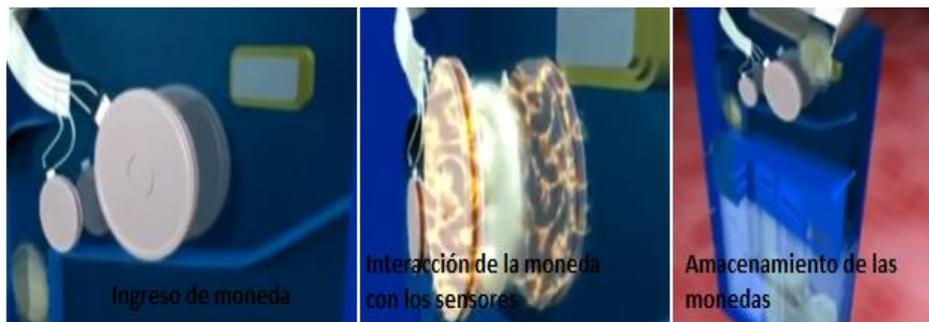
**Ilustración 1. 16 Funcionamiento de un monedero**
