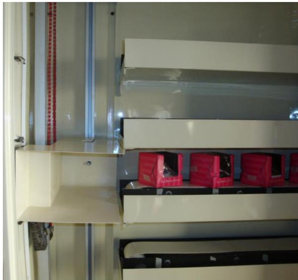
**Ilustración 3. 10 Ubicación de la cabina receptora en la parte media de la banda transportadora**
