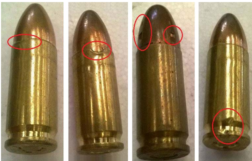
Figura 23. De izquierda a derecha: Deformación Superior del Cuerpo de la Bala, Hendidura Parte Superior de la Vaina, Muecas en la Bala, Aplastamiento en Parte Inferior de la Bala
