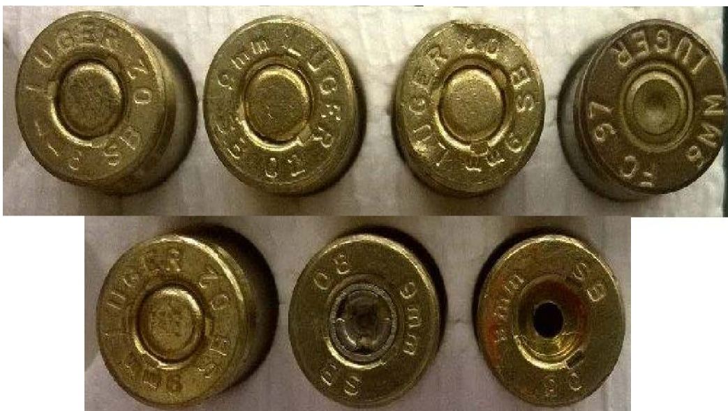
Figura 24. De izquierda a derecha: Codificación Errónea – Fulminante con Anillo Erróneo – Aplastamiento en la superficie de la Munición – Hendidura en Fulminante – Deformación en Fulminante – Fulminante armado al revés – Sin Fulminante
