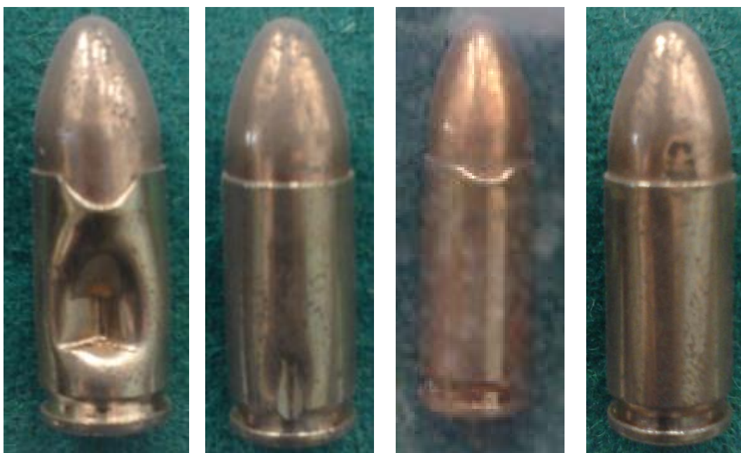
Figura 22. De izquierda a derecha: Deformación de la Vaina – Bala, Hendidura Parte Inferior de la Vaina, Fuerte Deformación Boca de la Vaina, Leve Deformación de la Bala [Foto Autorizada por la Empresa “Santa Bárbara” E.P]
