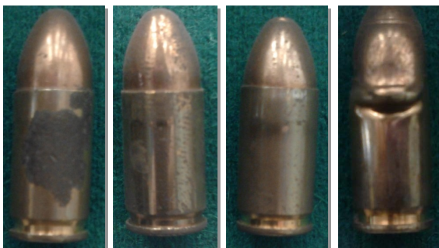
Figura 20. De izquierda a derecha: Mal pulimiento de Vaina, Golpe en Vaina, Deformación Punta de Bala, Fuerte Deformación de Bala [Foto Autorizada por la Empresa “Santa Bárbara” E.P]
