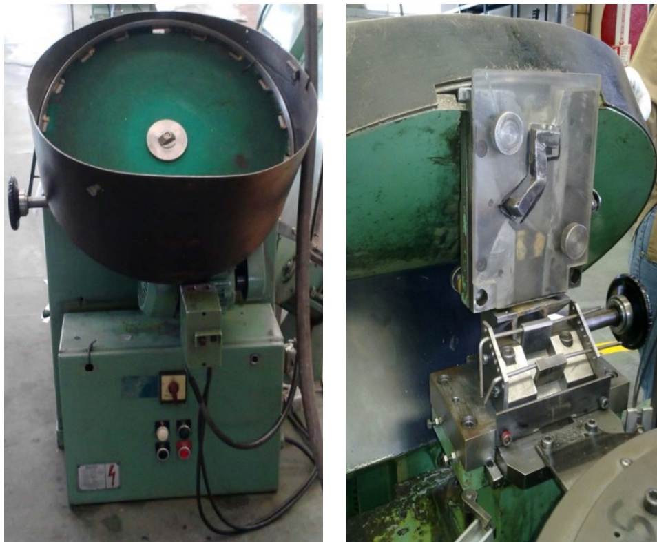
Figura 16. Feeder (lado izquierdo) y Mecanismo de Colocación Horizontal para las Municiones hacia el Sistema de Pesaje (lado derecho) [Foto Autorizada por la Empresa “Santa Bárbara” E.P]
