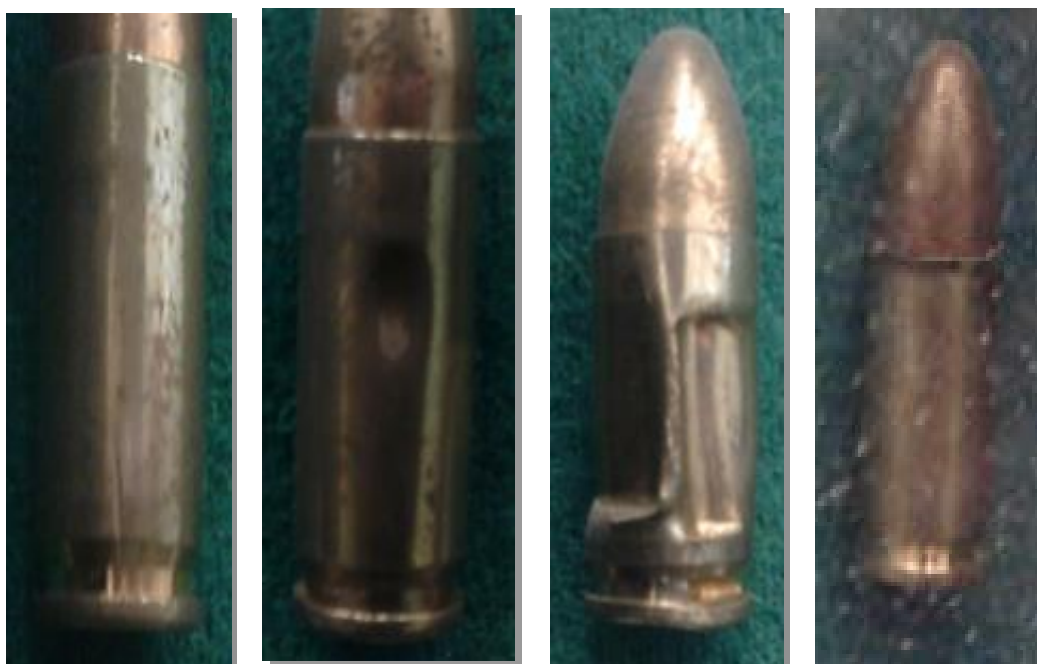
Figura 21. De izquierda a derecha: Raya leve en la parte inferior de la Vaina, Abolladura de la Vaina, Aplastamiento en máquina, Rebaba de la Vaina [Foto Autorizada por la Empresa “Santa Bárbara” E.P]
