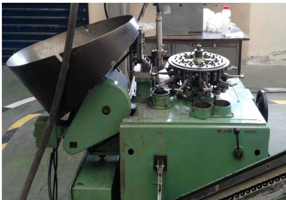
Figura 15. Vista Frontal de la Máquina de Pesaje Tipo PC 56 [Foto Autorizada por la Empresa “Santa Bárbara” E.P]
