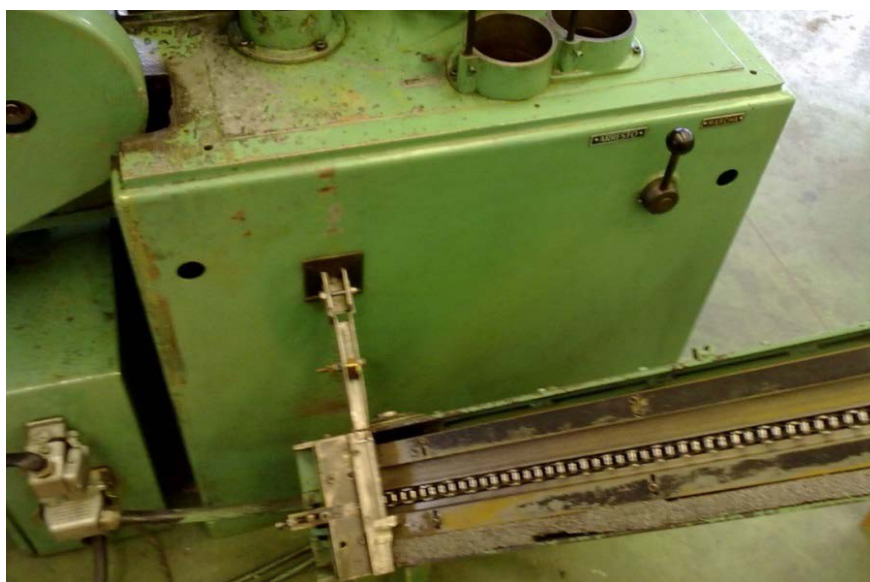
Figura 18. Vista lateral de la Estación de Pesaje mostrando el agujero de salida con la Munición con el Peso Exacto [Foto Autorizada por la Empresa “Santa Bárbara” E.P]
