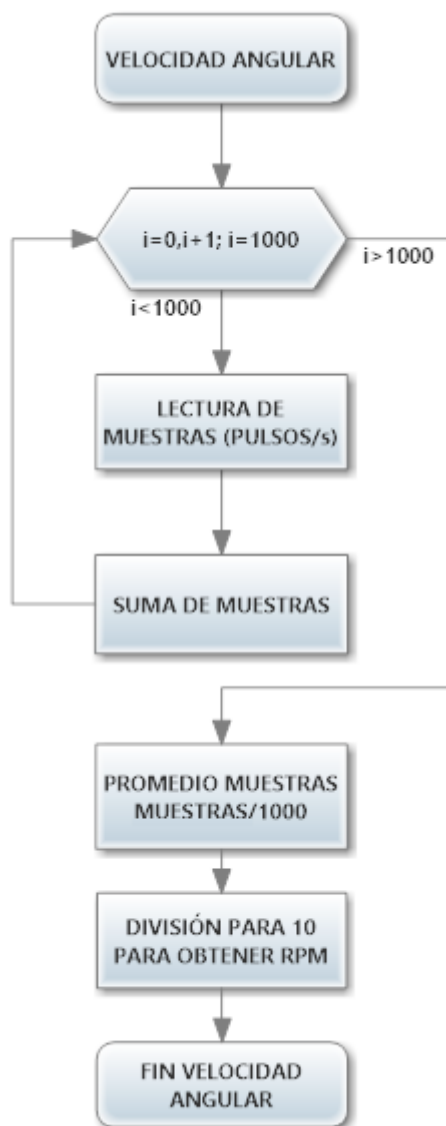
Figura 42. Diagrama de flujo de la programación para la interpretación de la velocidad angular sensada.
