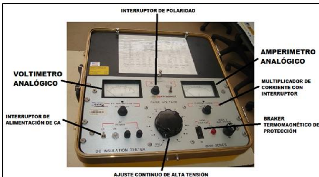
Figura 8: Tablero de control de HI – POT -120 Kv.
