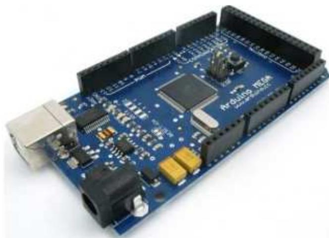
Figura 68. Microcontrolador Arduino Mega
