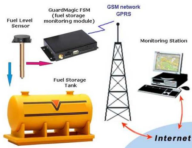
Figura 8. Control de tanques de Petróleo
