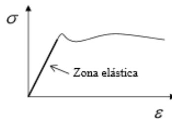
Figura 6. Curva de Deformación
