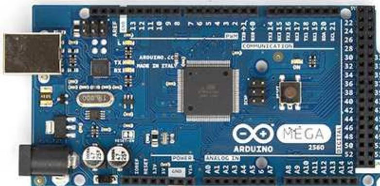
Figura 22. Arduino Mega 2560
