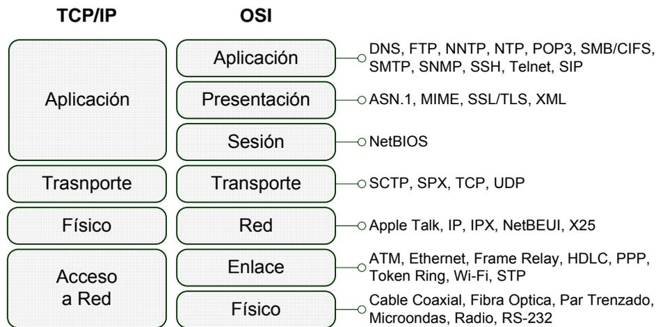
**Figura 1.9. Modelo de red TCP/IP & OSI y protocolos principales**
