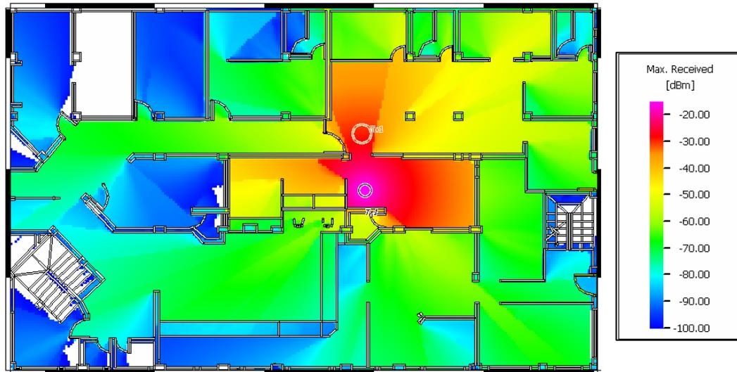
Figura 4.2. Potencia recibida en la primera planta con un Tx de 19 dBm ubicado en otro sitio.
