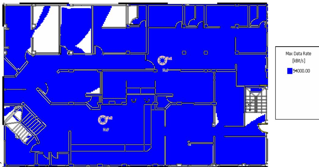
Figura 4.4. Tasa máx... De datos recibida en la primera planta con dos Tx de 19 dBm
