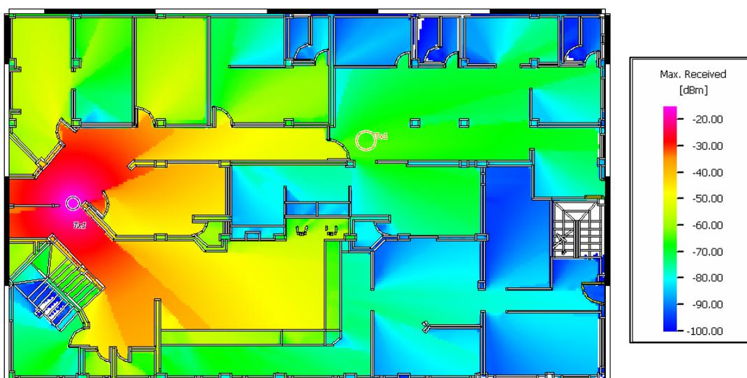
Figura 4.1. Potencia recibida en la primera planta con un Tx de 19 dBm.
