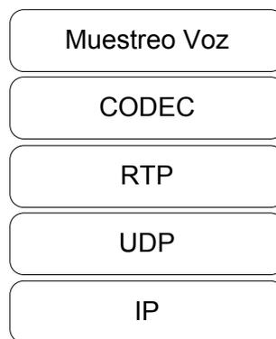
**Figura 2.8. Pila de protocolos RTP**
