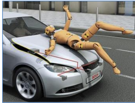
Figura 7: Sistema de protección de peatones
