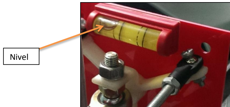
Figura 34. Nivel ubicado en la parte posterior de la placa frontal
