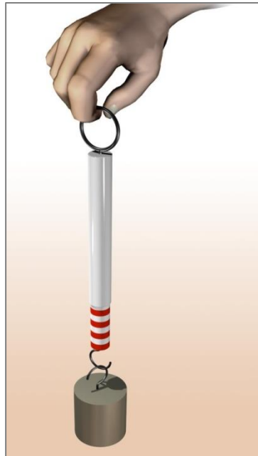
Figura 23. Determinación de la fuerza experimentalmente con el dinamómetro
