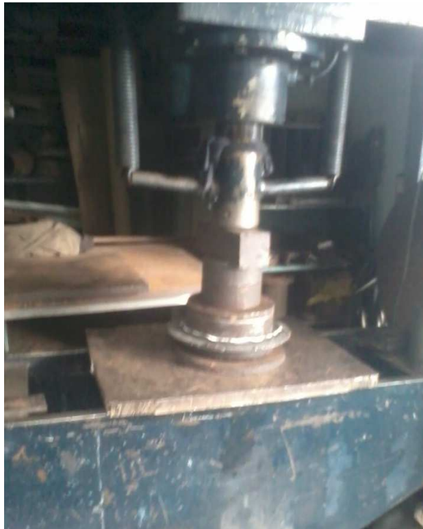
Figura 37 Proceso de prensado de tapas para recipiente
