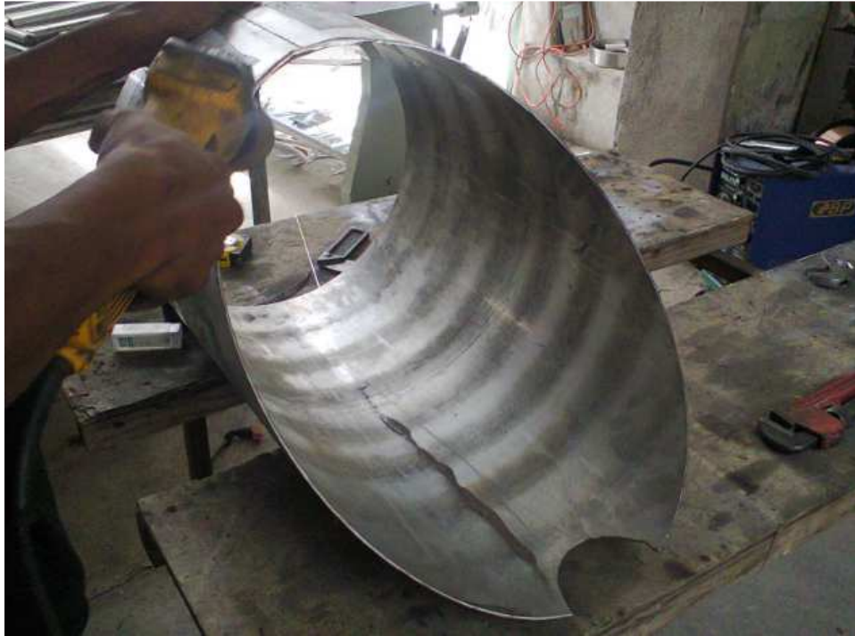
Figura 41 Remoción de viruta de un recipiente
