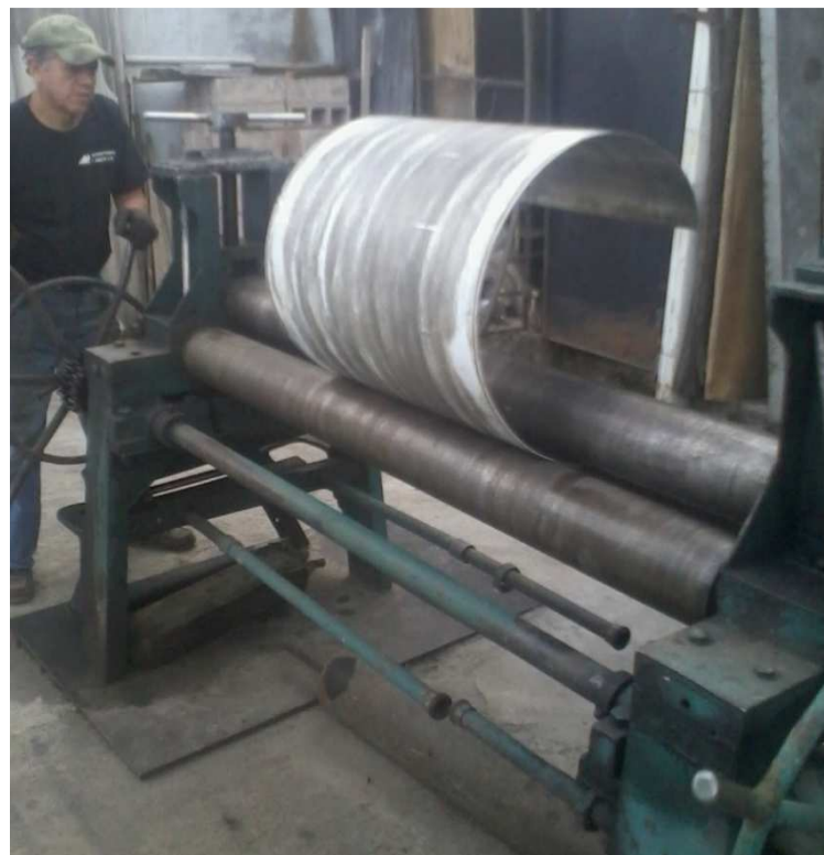
Figura 36 Proceso de rolado de la plancha acero
