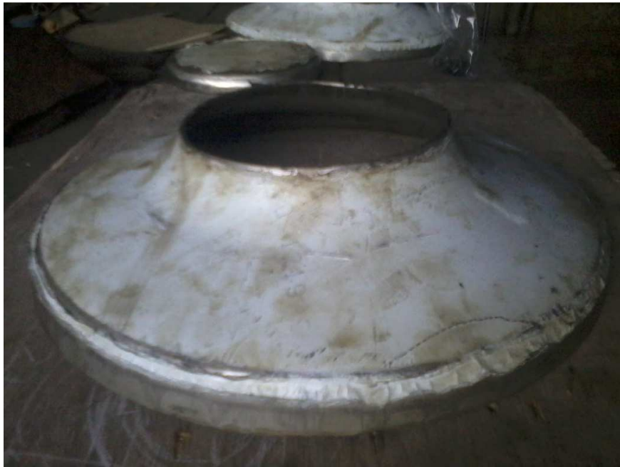
Figura 39 Proceso final de prensado de fondos y tapas
