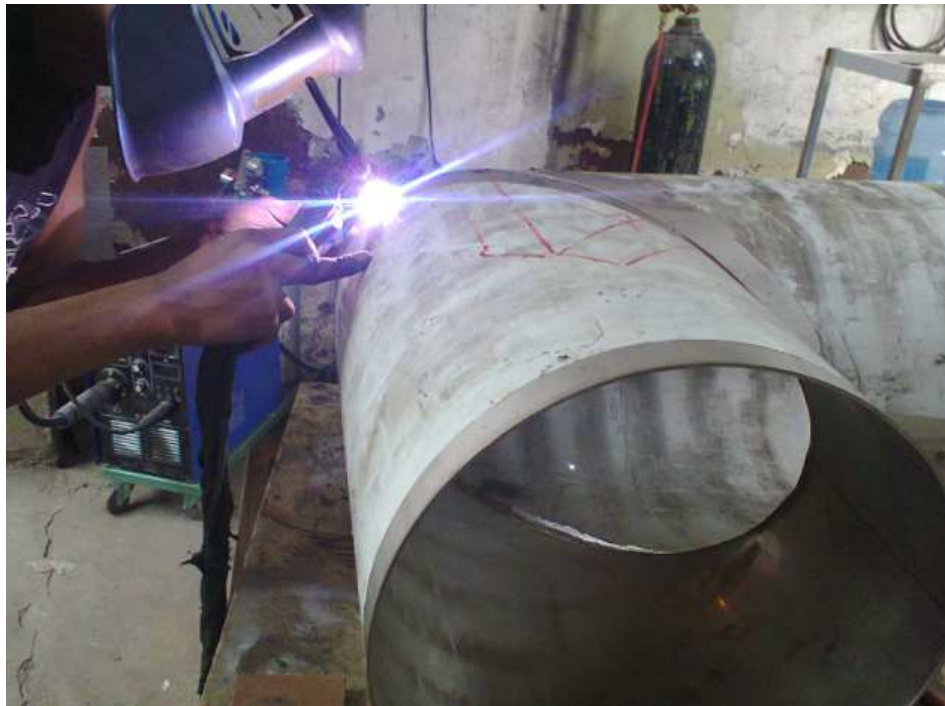
Figura 42 Soldado del recipiente del mezclador
