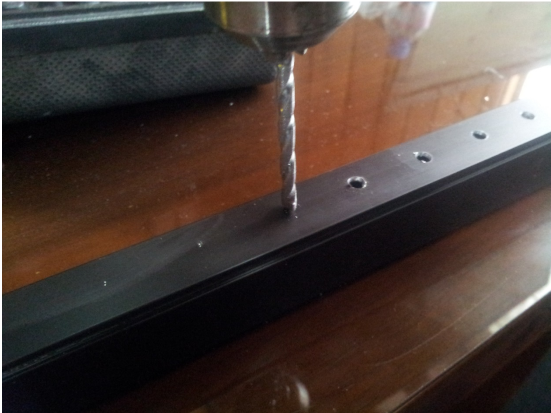
Figura 3.3 Preparación de Marco de aluminio
