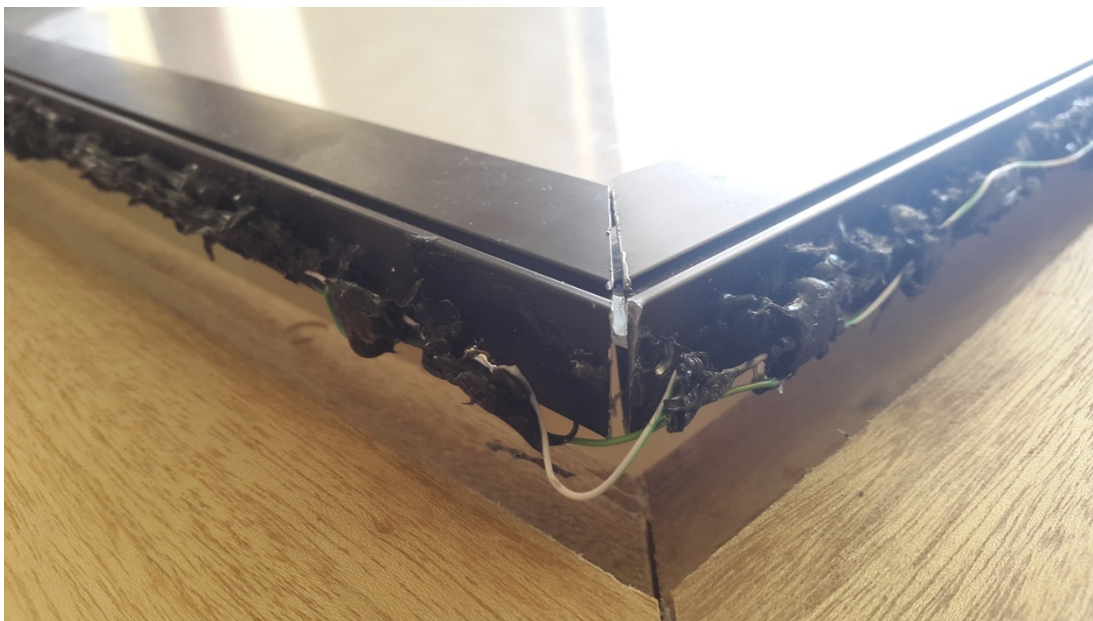
Figura 3.14 Posibles filtraciones de luz en el marco
