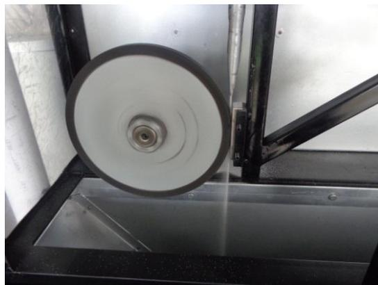
Figura 172. Ensayo de abrasión.
