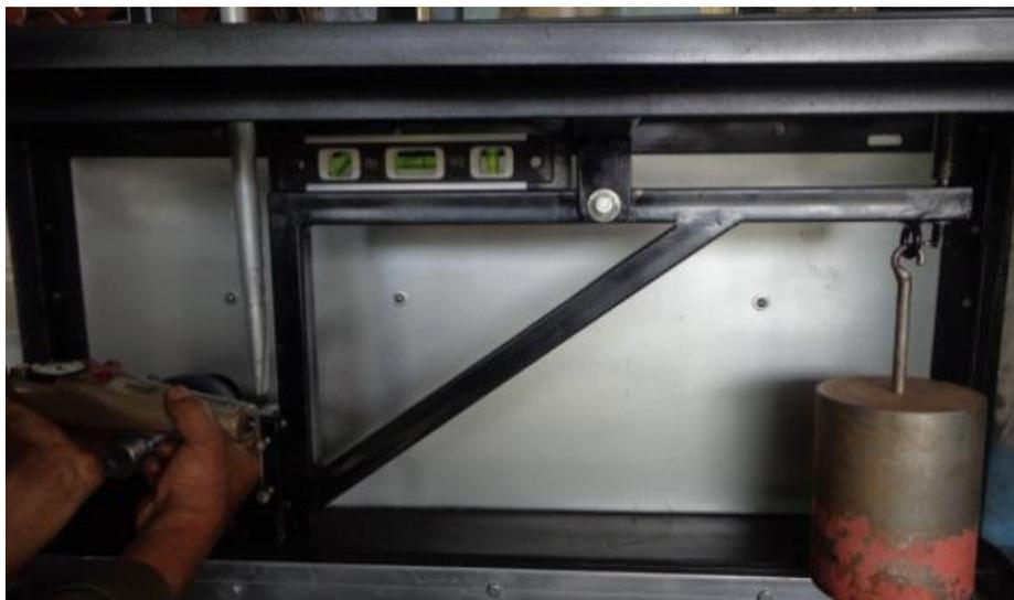
Figura 162. Pruebas de fuerza para brazo de palanca con dinamómetro en extremo probeta.
