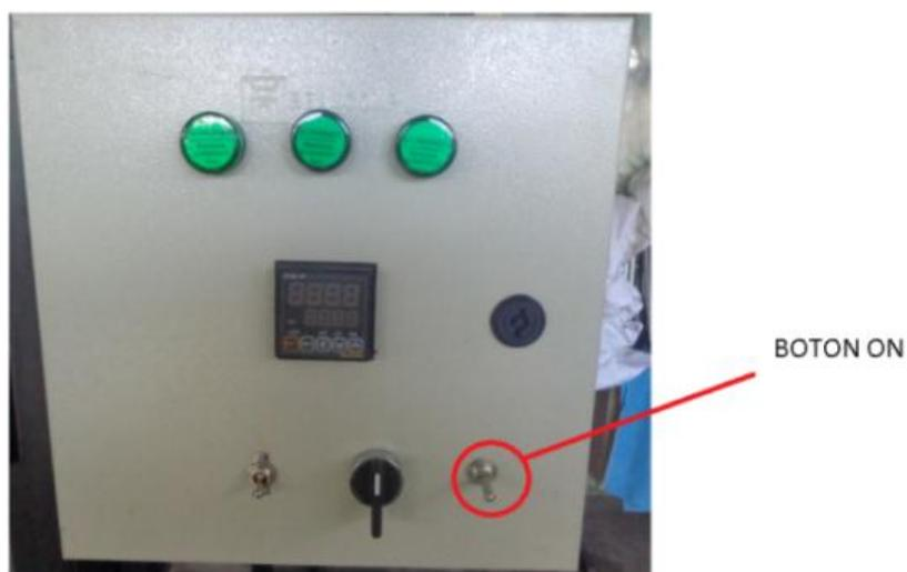
Figura 158. Panel de control de la máquina de abrasión.
