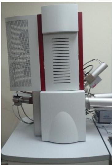
Figura 184. Microscopio electrónico de barrido MIRA3 TESCAN.
