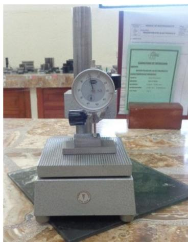
Figura 177. Medición de profundidad del desgaste abrasivo en probeta AISI 4340.
