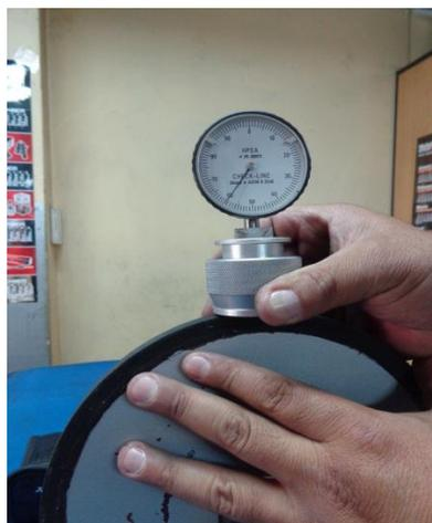
Figura 160. Pruebas de dureza shore A
