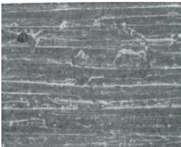
Figura 23. Desgaste abrasivo de dos cuerpos
