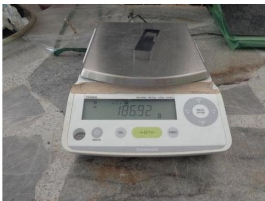
Figura 174. Peso de probeta luego del ensayo de abrasión.
