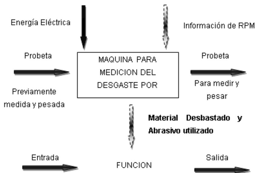
Figura 44. Funciones de la máquina de abrasión
