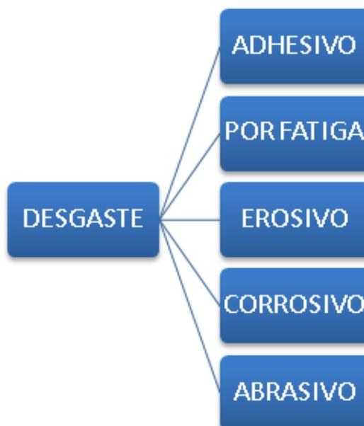
Figura 15. Clasificación del desgaste
