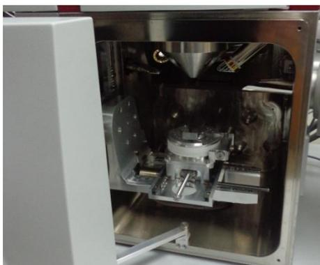
Figura 185. Colocación de probeta AISI 4340 en microscopio electrónico de barrido MIRA3 TESCAN.
