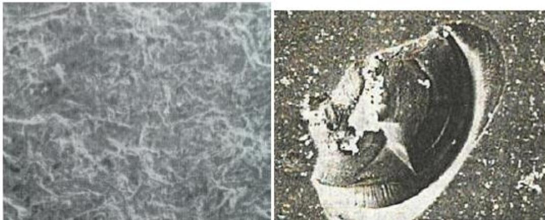
Figura 20. Superficie con desgaste erosivo
