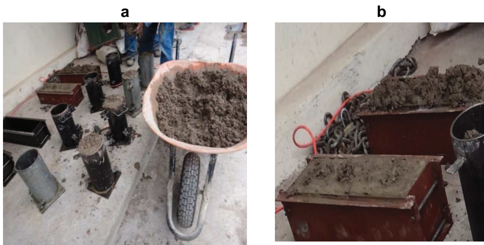
Figura 14 Colocación del hormigón en a – cilindros; b – vigas.
