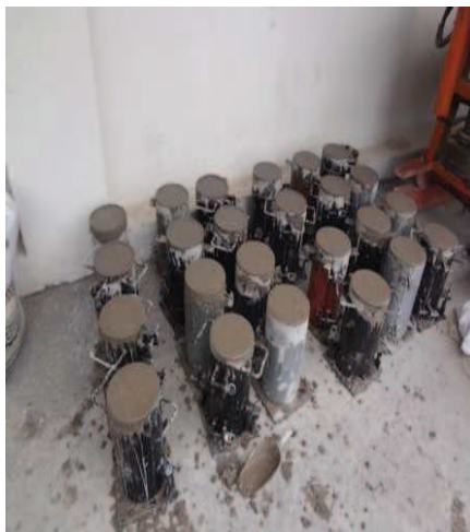
Figura 15 a – Control de la temperatura; b – Revenimiento de la mezcla; c - Cilindro terminado.
