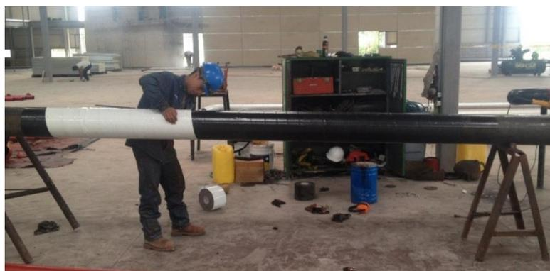
Figura 58. Recubrimiento anticorrosivo POLYKEN para tubería enterrada
