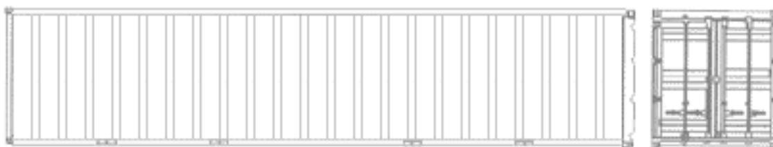
Figura 2.2. Contenedor 40 pies (12 m) para carga sólida 20'x 8'x 8',6" ISO 1-AA
