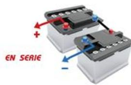
**Figura 4.22. Arreglo de Baterías sistema VDC del PCR**
