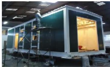
**Figura 2.26. Proceso de pintura de un PCR Contenerizado**
