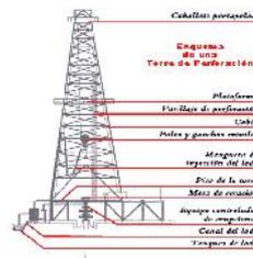
**Figura 2.8. Esquema de una Torre de Perforación**
