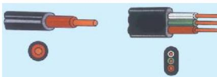
**Figura 3.14. Cables mono-conductor y multi-conductor**
