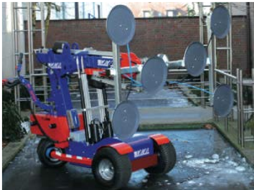
Figura 36. Robot cristalero KS600 SpainCrane.
