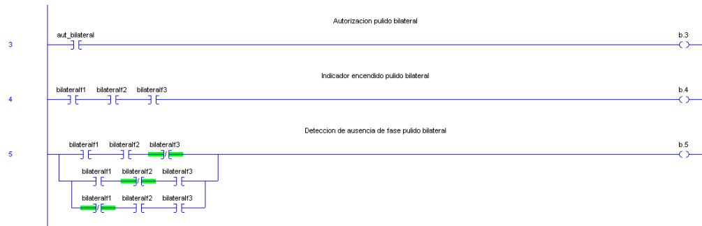
Figura 84. Programación ladder del sistema de monitoreo (parte 2).
