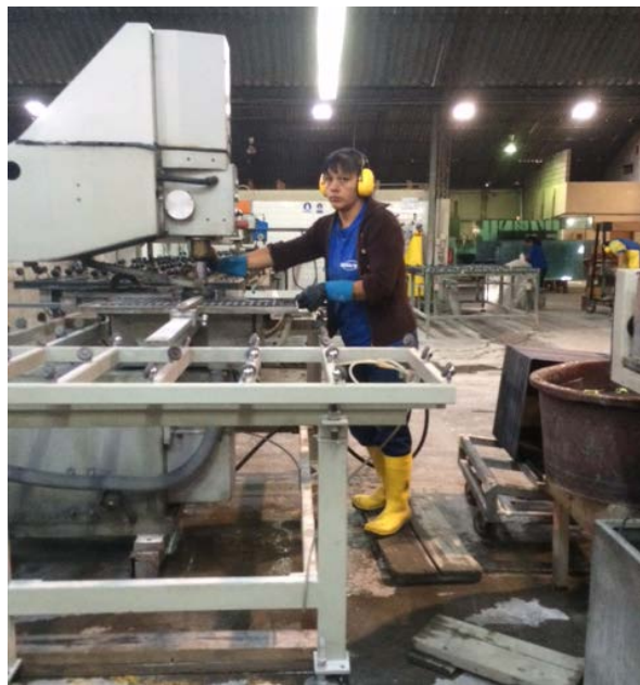
Figura 18. Proceso de perforado.
