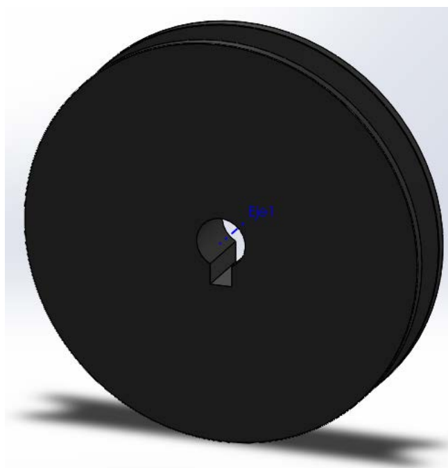
Figura 60. Vista isométrica polea del motorreductor.
