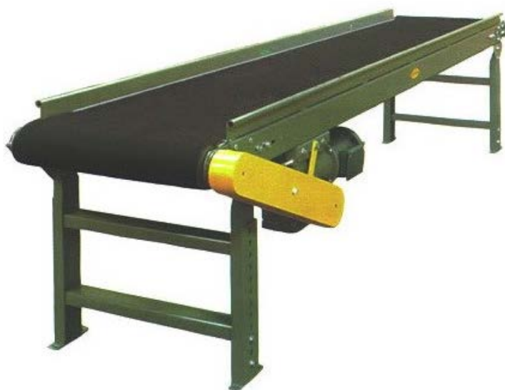
Figura 39. Banda transportadora horizontal industrial.
