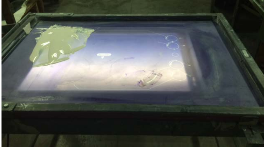
Figura 23. Serigrafía con pintura blanca.
