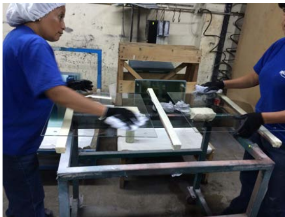
Figura 20. Inspección inicial del vidrio.
