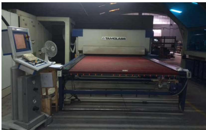
Figura 24. Horno de templado.
