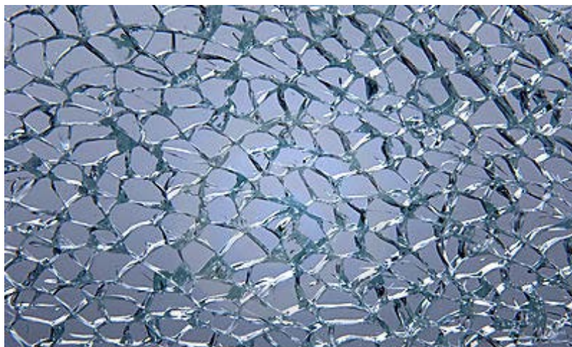
Figura 1. Vidrio templado fragmentado ante impacto.
