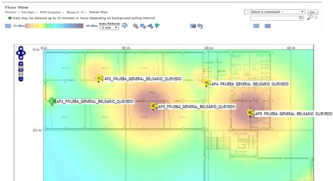
Figura 47. Cobertura y potencia de la señal de AP's en el área de Oficinas y Aulas en el Bloque A y B del Edificio Central
