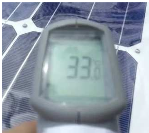
Figura 4.11: Medición de temperatura de matriz
