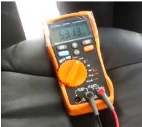
Figura 4.9: Medición voltaje de batería
