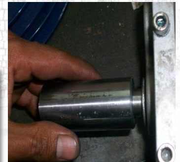
CONSTRUCCIÓN ACOPLE EJE MOTOR
