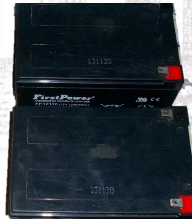
BATERIAS 12V 12Ah
