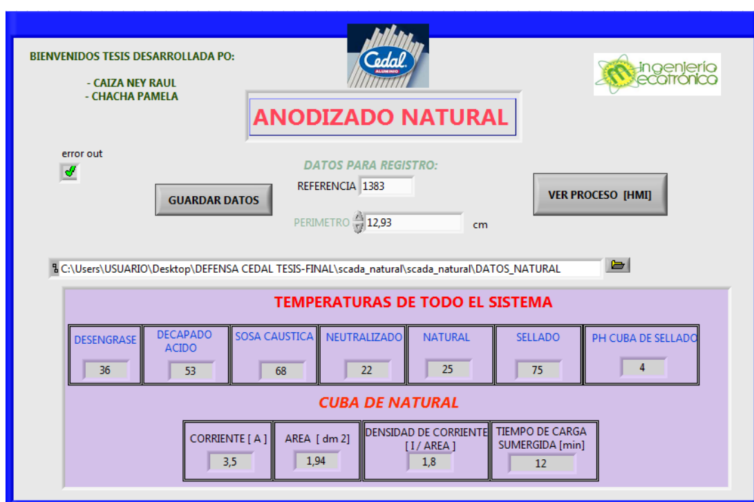
Figura 4.7 Pantalla principal del sistema de monitoreo y de adquisición de datos SCADA
