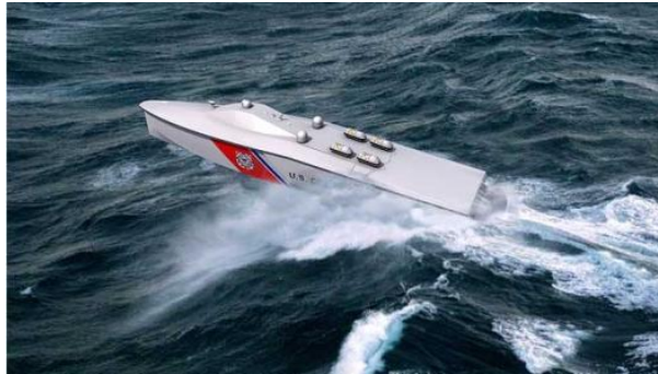
Figura 2-3 "Piraña" USV reforzado con fibra de carbono. Fuente. http://www.gizmag.com/nanotube-reinforced-carbon-fiber-piranha-usv/14321/
