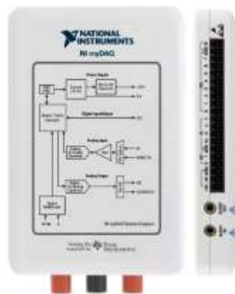
Figura 3. 20. NI MyDAQ y su conexión al PC.
