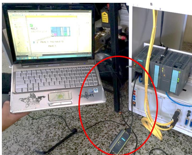
Figura 3.19. Conexión del PLC mediante cable MPI.
